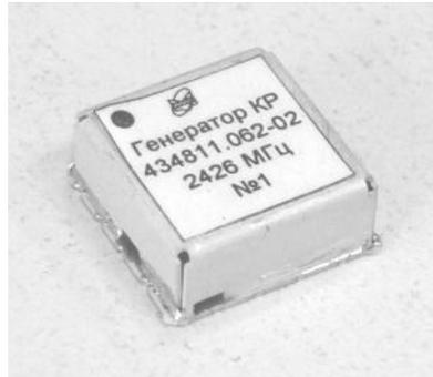
Рисунок 3.20 – Фото генератора на коаксиальном керамическом резонаторе (разработан автором)
