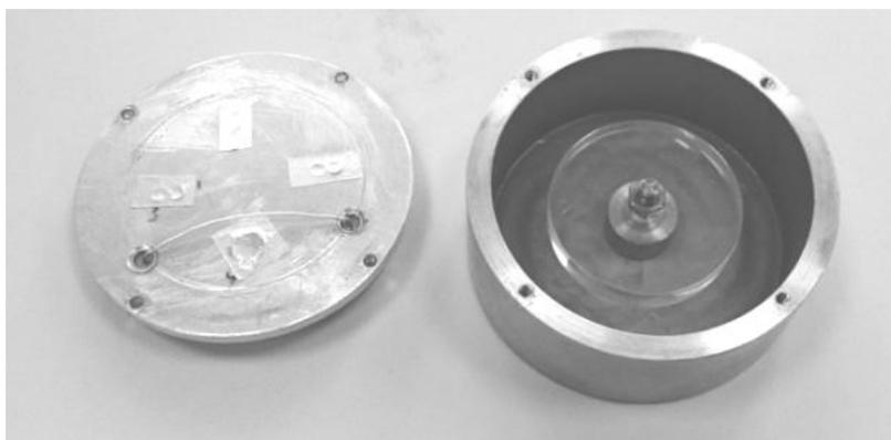
Рисунок 3.6 – Фото макета резонатора с устройством выделения отраженной волны
