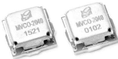
Рисунок 3.22 – Фото ГУН 2-4 ГГц MVCO-2040-SF (разработан автором)
