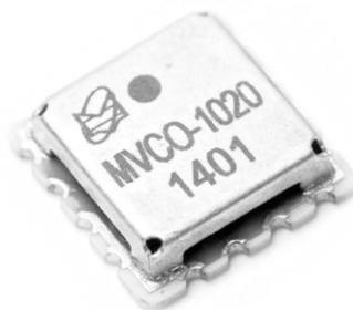
Рисунок 3.21 – Фото октавного ГУН 1-2 ГГц MVCO-1020 (разработан автором)
