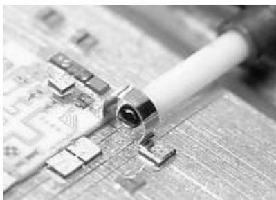
Рисунок 1.22 – Фото ЖИГ-резонатора (черный шар) в генераторе
