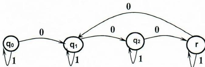
Данный автомат определяет язык, в котором допустимыми являются все цепочки в алфавите  $\{0,1\}$ , в которых \_\_\_\_\_.
