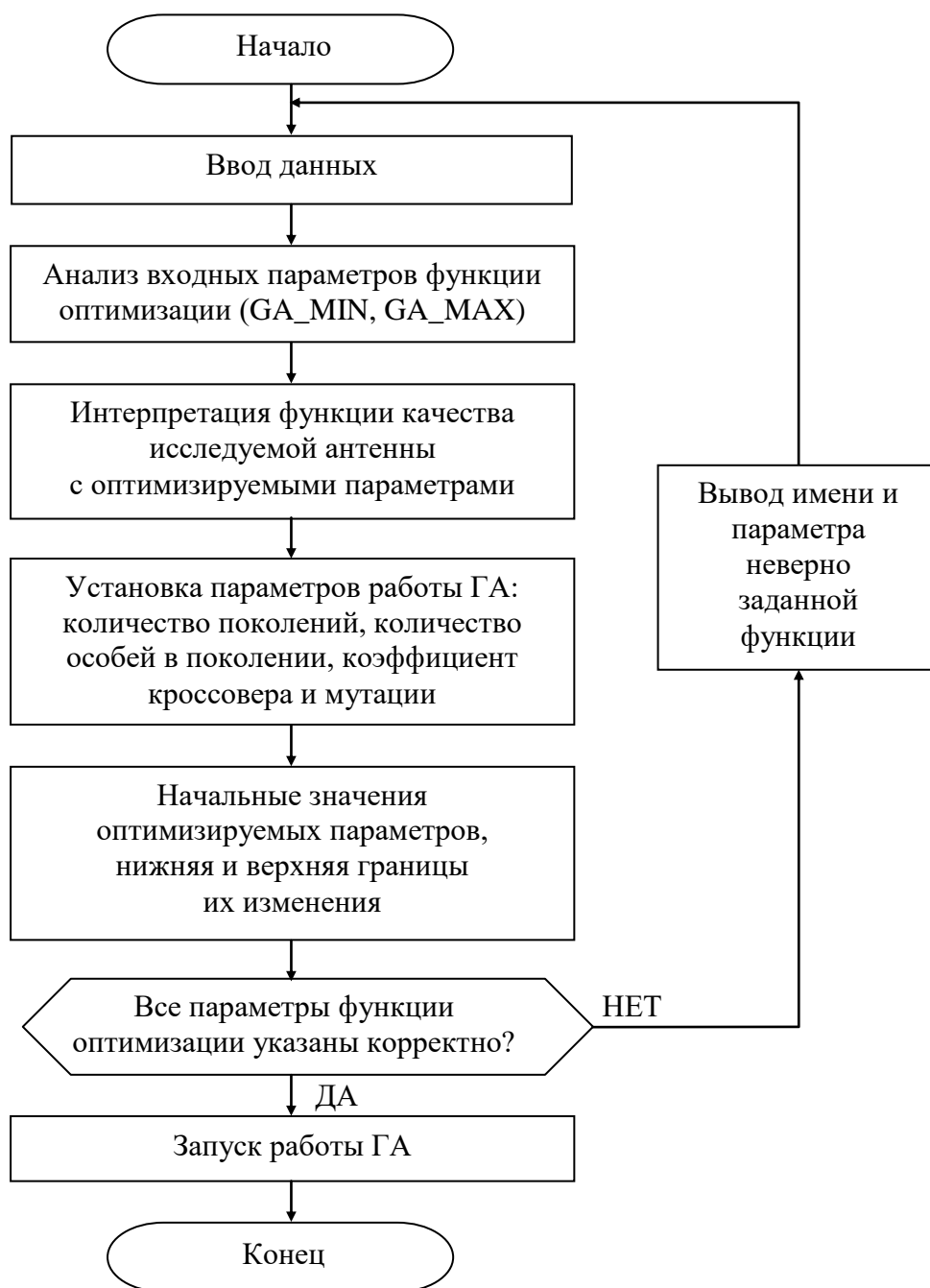
Рисунок 3.14 – Алгоритм настройки и запуска ГА в системе для комплексной оптимизации радиоэлектронных устройств
