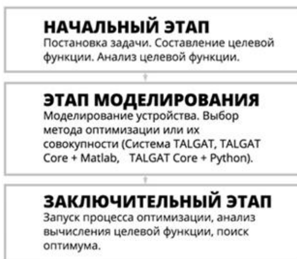
Рисунок 2.1 – Методика моделирования элементов радиоэлектронных устройств
