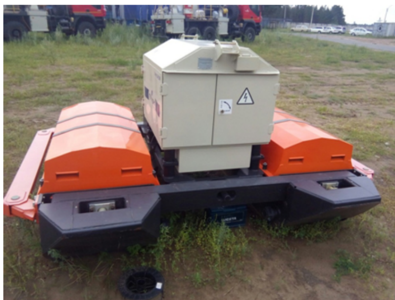
Рис. 4.21: Импульсный невзрывной сесмоисточник серии «Енисей» СЭМ-100. Сила воздействия на грунт P=100 тонн (1000 кН).
