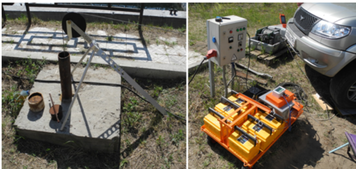
Рис. 4.13: Экспериментальный макет во время испытаний на МнУИГЦ. Слева – сейсмический зонд, погружаемый в скважину. Справа – сейсмоисточник с пригрузом и приемник на базе сейсмостанции.
