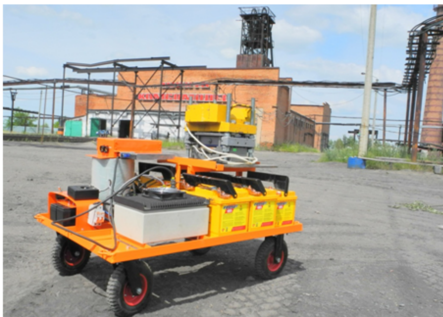
Рис. 4.2: Ствол №1 шахты «Комсомолец», ОАО «СУЭК-Кузбасс». Сейсмический излучатель.
