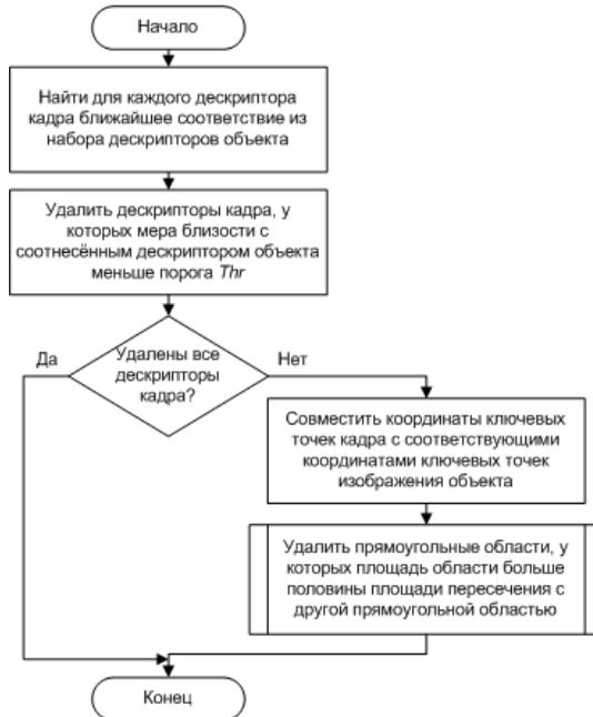
Рисунок 2 – Блок-схема алгоритма ограничения области поиска
