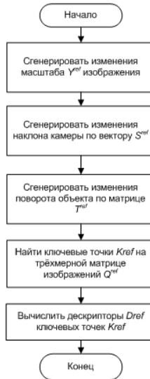
Рисунок 5 – Блок-схема функции вычисления дескрипторов объекта на проективно искажённых изображениях
