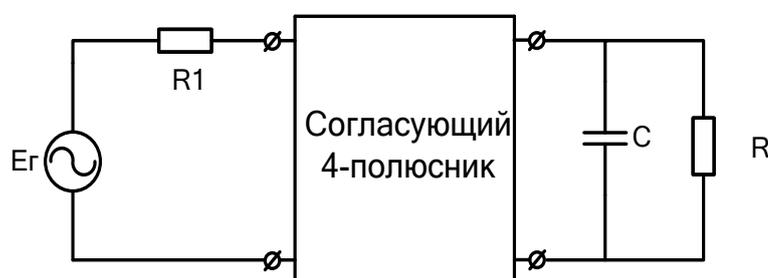
Рисунок 2.9 – Согласование комплексных нагрузок
