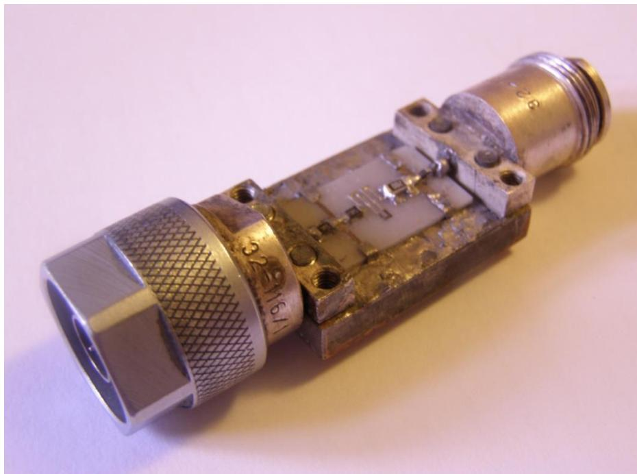
Рисунок 4.2 – Двухкаскадный СВЧ аттенюатор на симметричной Т-образной структуре
