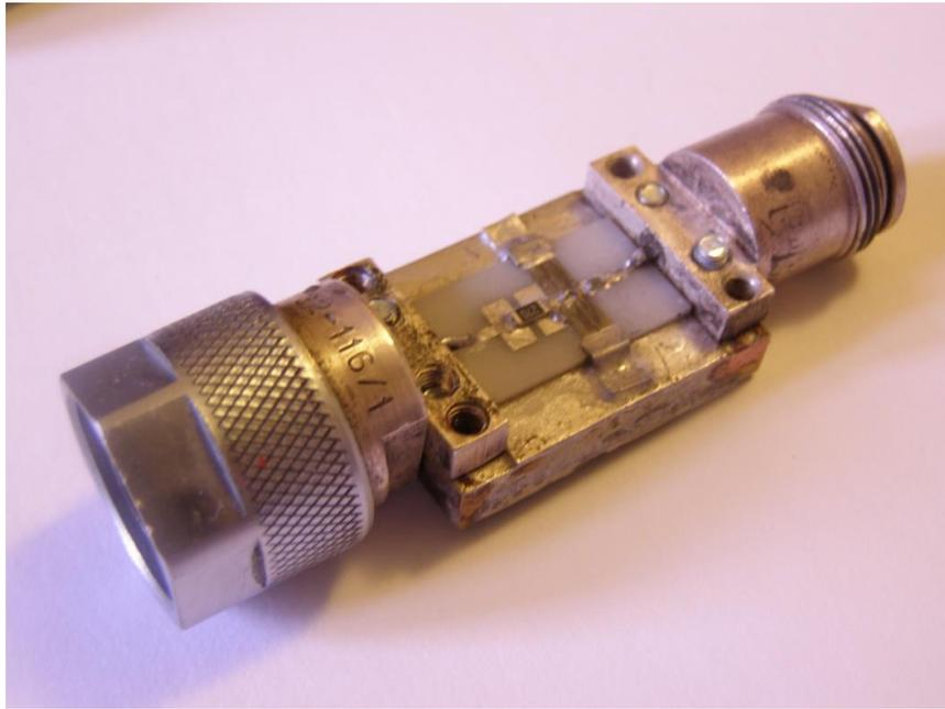
Рисунок 4.1 – Однокаскадный СВЧ аттенюатор на симметричной Т-образной структуре
