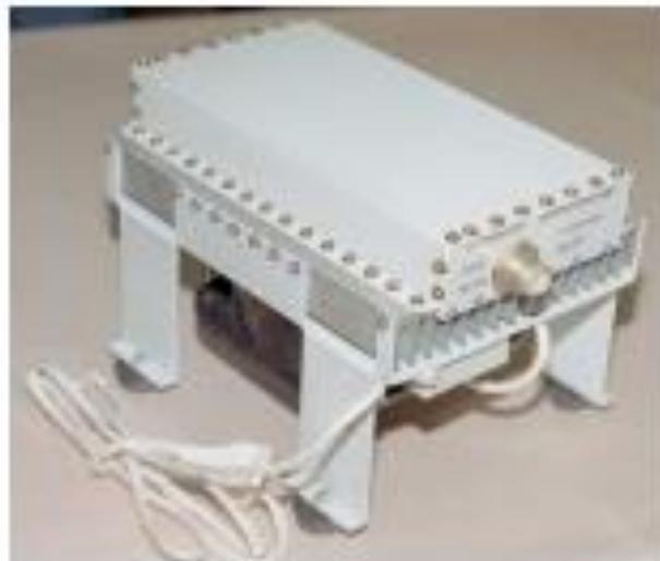
Рисунок 4.10 – СВЧ аттенюатор (внешний вид) на уровень мощности 100 Вт с коэффициентом затухания 20 дБ
