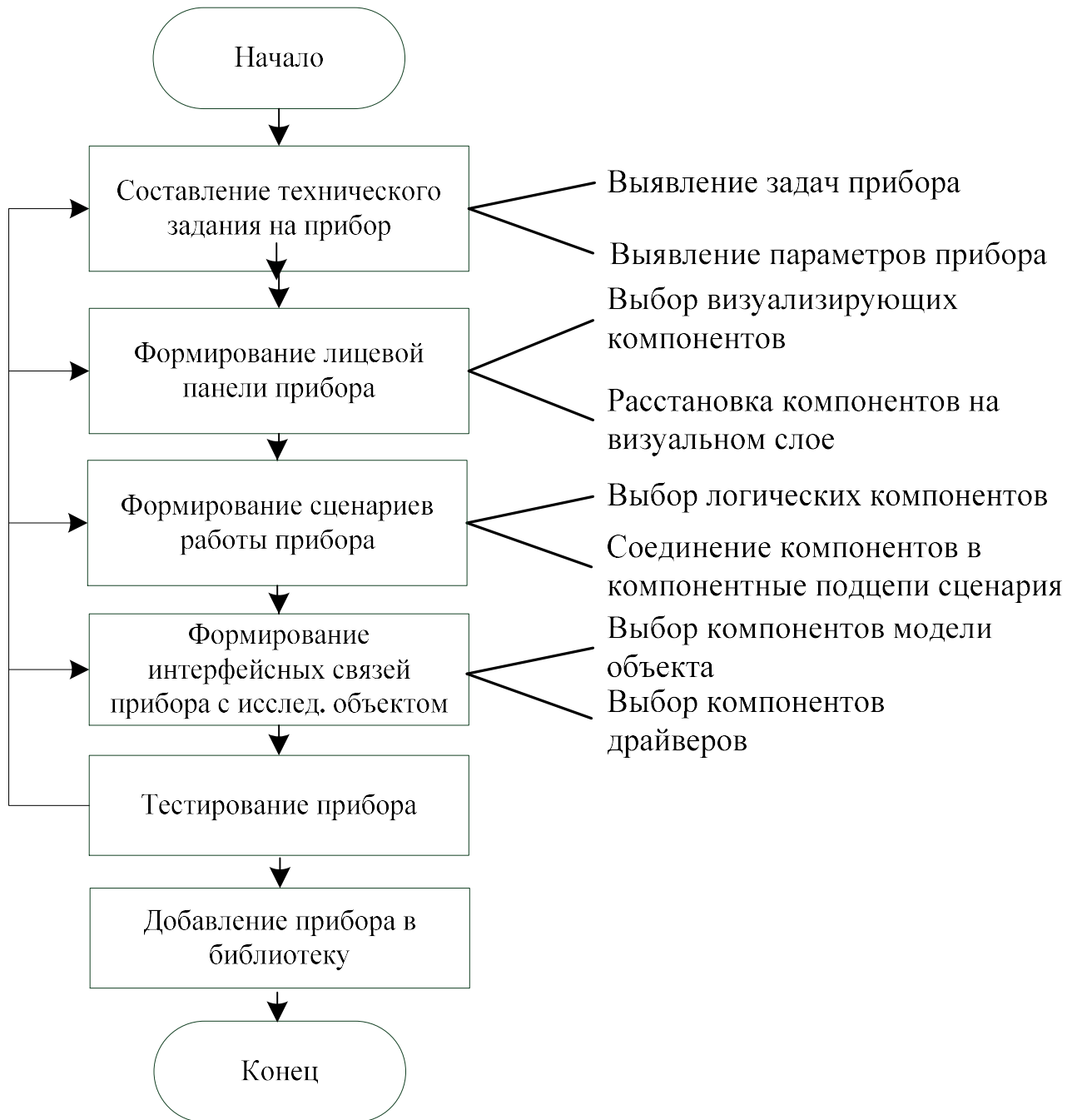
Рисунок 5.3 – Последовательность действий пользователя по формированию виртуального прибора
