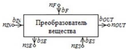
Рисунок 2.9 – Обобщенный компонент «Преобразователь вещества»
