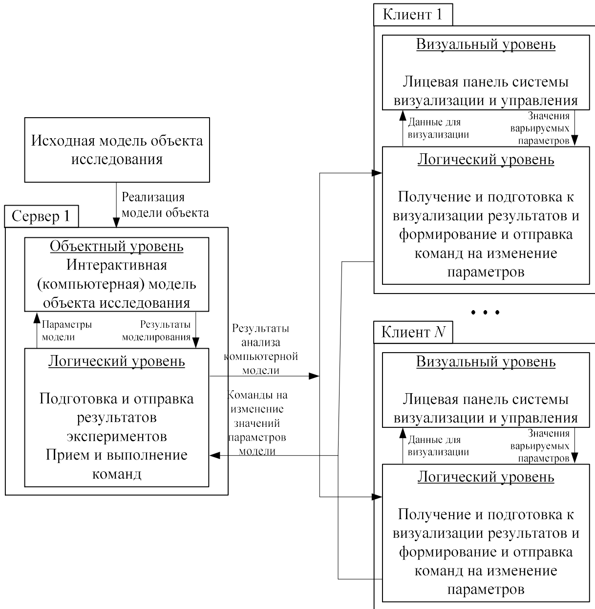
Рисунок 7.17 – Структура распределенной многоуровневой компьютерной модели для реализации сетевого тренажера
