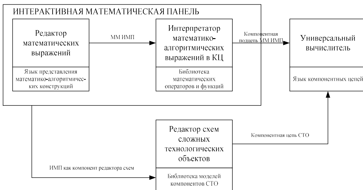
Рисунок 6.36 – Структура интерактивной математической панели и ее взаимосвязь с другими модулями комплекса программ МКМ СТУС
