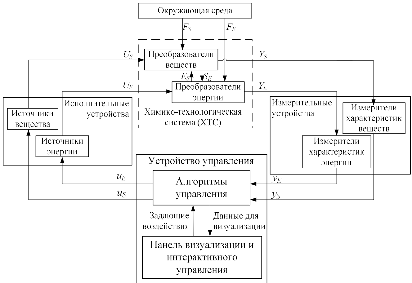
Рисунок 1.1 – Структурно-функциональная схема сложной технической (технологической) управляемой системы
