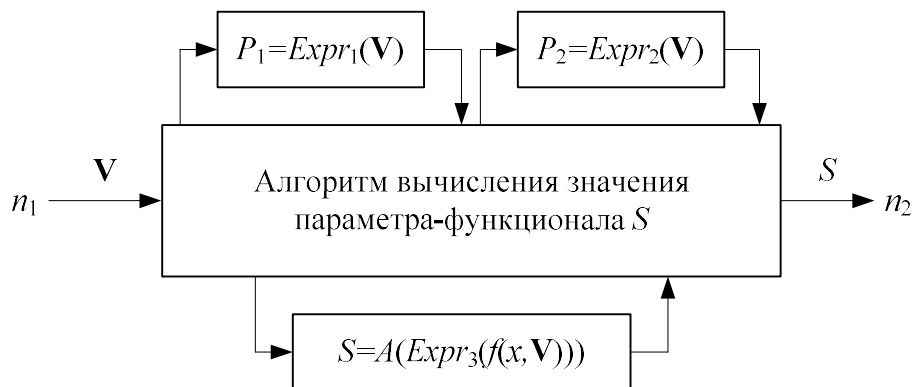
Рисунок 4.12 – Структура компонента «Функционал»
