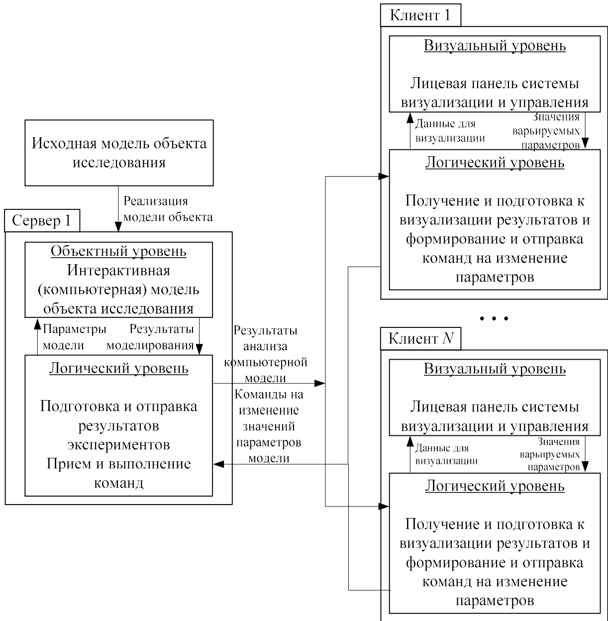
Рис. 19. Структура распределенной многоуровневой компонентной цепи для реализации сетевого тренажера
