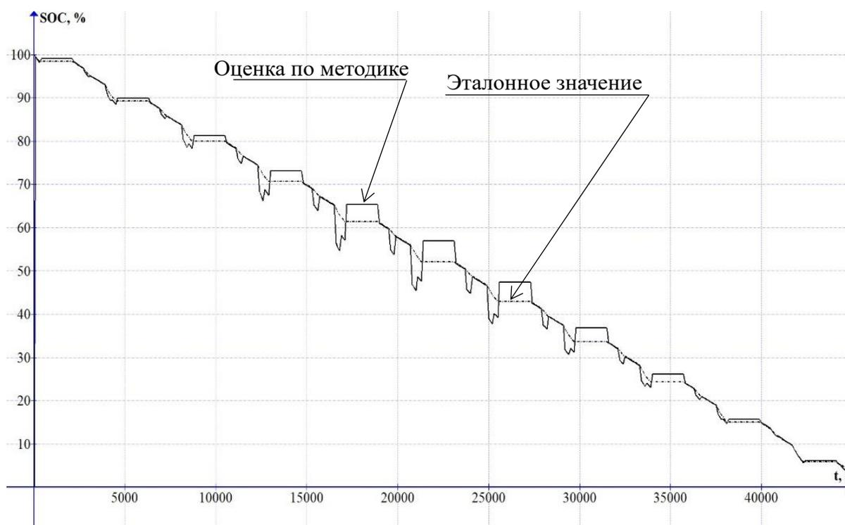
Рисунок 4 – погрешность оценки степени заряженности при изменении температуры
