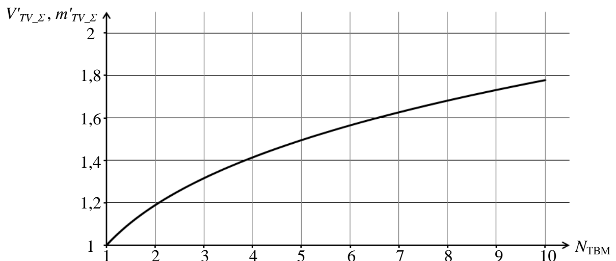
Рисунок 2.35 – График зависимости относительного суммарного объема и массы трансформаторов ДТМП с N -ТВМ от количества ТВМ
