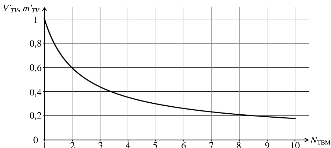
Рисунок 2.34 – График зависимости относительного объема и массы любых элементов одного трансформатора ДТМП с N -ТВМ от количества ТВМ
