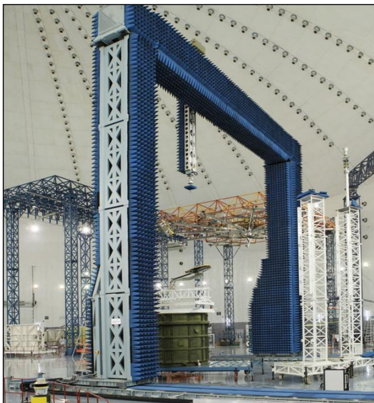
Рисунок 3.5 – Внешний вид радиотехнического сканера с горизонтальной поверхностью сканирования
