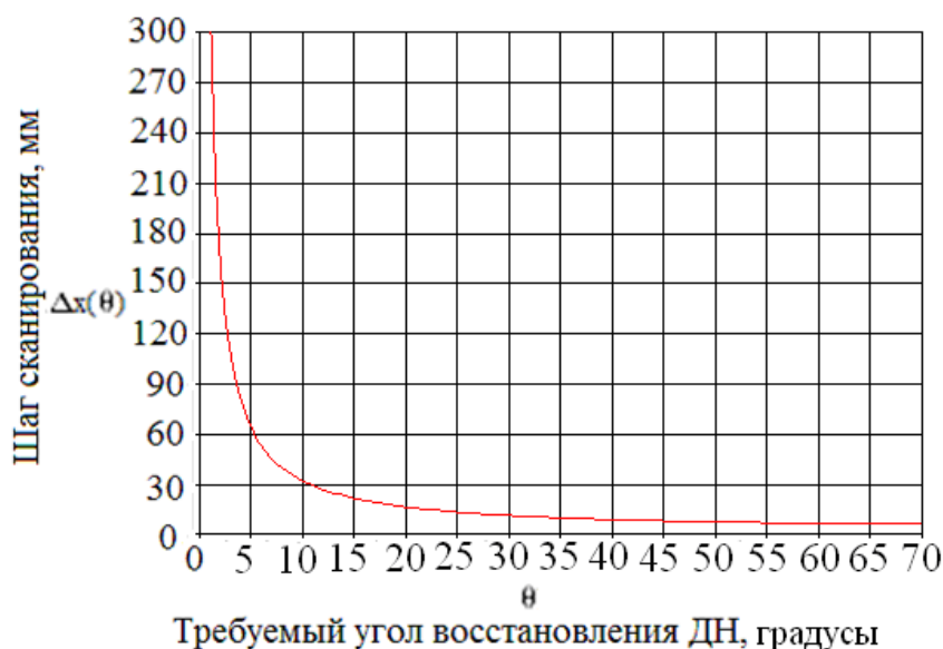
Рисунок 5.5 – Зависимость величины шага сканирования от требуемого угла восстановления ДН
