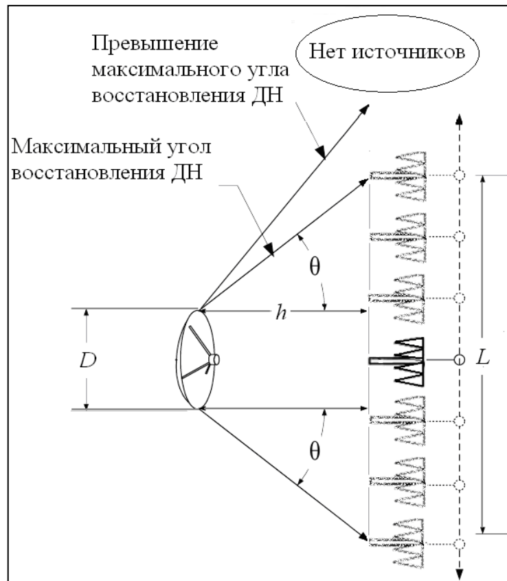
Рисунок 1.6 – Схематическое представление исследуемой антенны и плоскости сканирования, поясняющее выражение (1.8)
