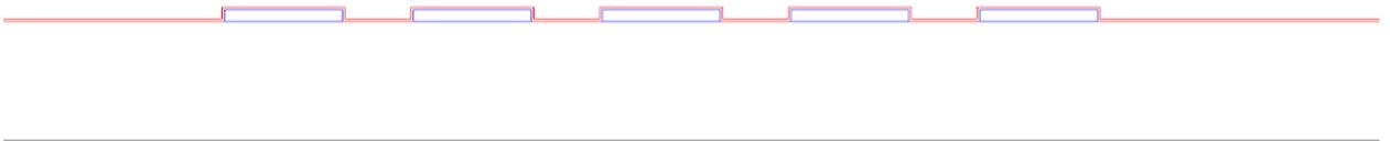
Рисунок 3.5 – Поперечное сечение пятипроводной линии передачи
