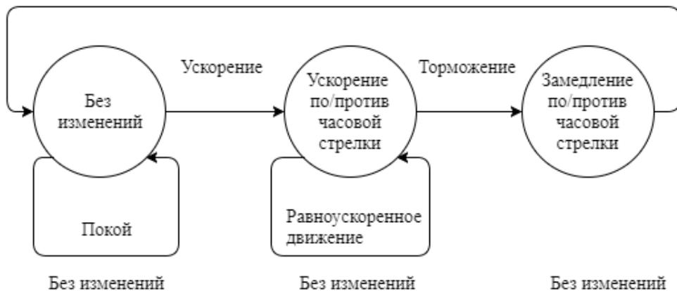
Рисунок 3.8 – Граф возможных переходов динамических состояний ГТМ
