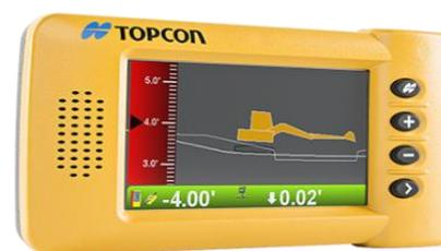
Рисунок 1.5 – Сенсорный вычислительный блок GX-30
