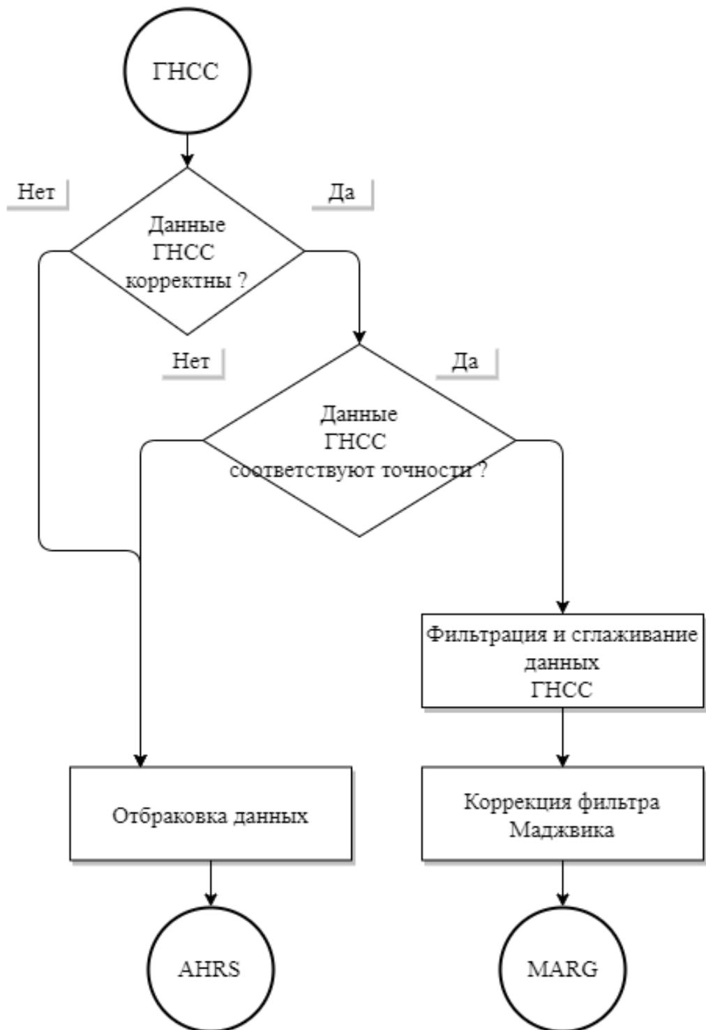
Рисунок 2.14 – Часть программы подготовки данных для передачи комплексующему фильтру Маджвика (фрагмент подготовки данных ГНСС)
