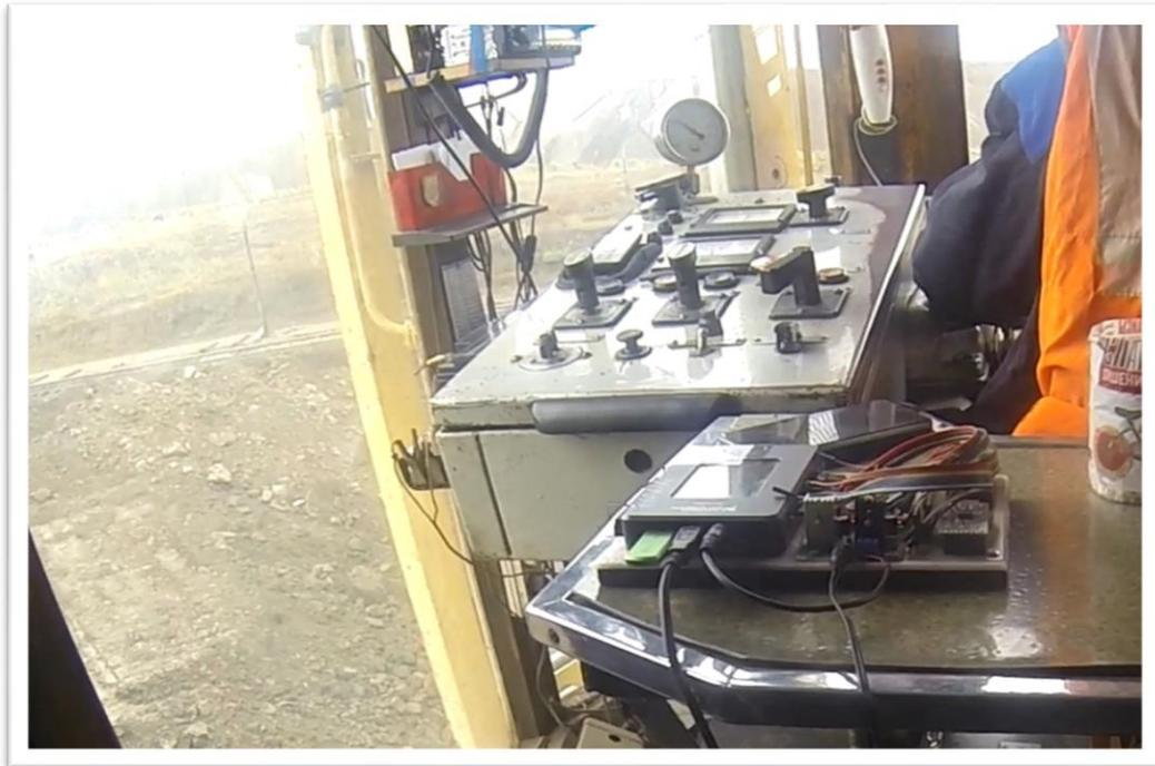
Рисунок 4.9 – Опытный образец АСМП в 2017 году на экскаваторе ЭШ10/50
