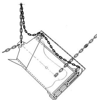
Рисунок 2.3 – Положение ковша драглайна во время транспортировки на разгрузку
