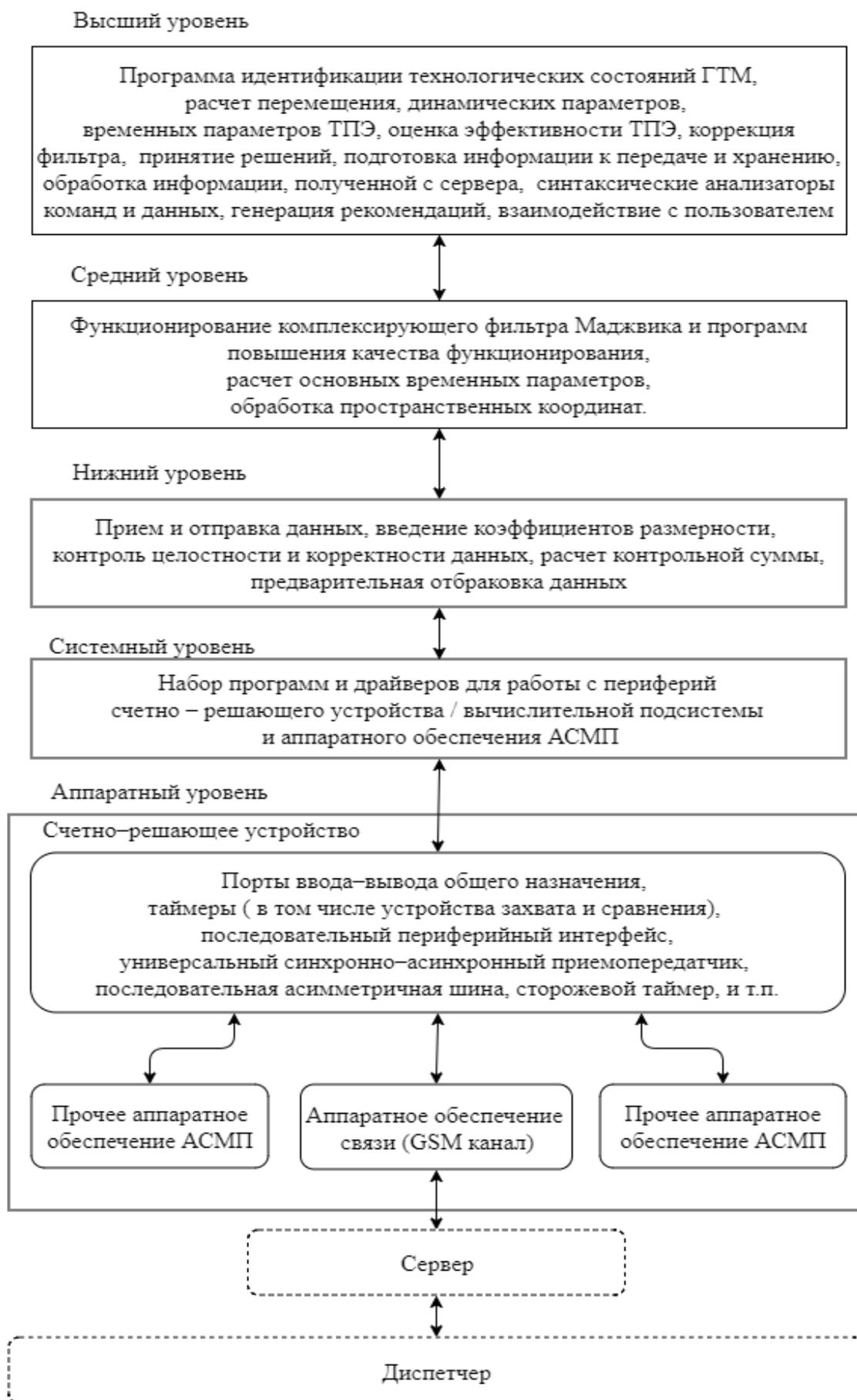
Рисунок 2.15 – Структура уровней программного обеспечения АСМП
