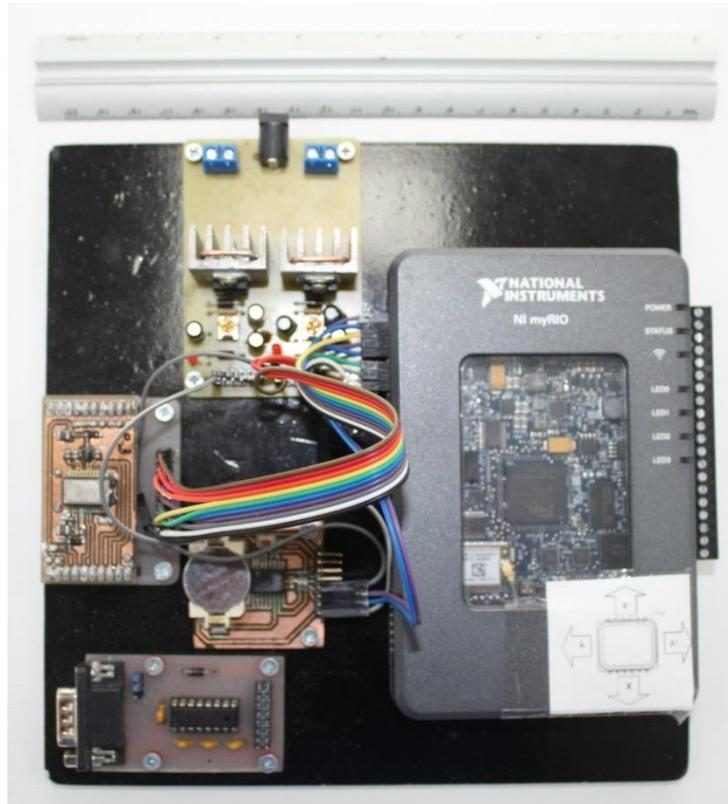
Рис. Е.1. Система автоматизированного сбора и обработки данных в комплектации с ИИМ SCC2230
