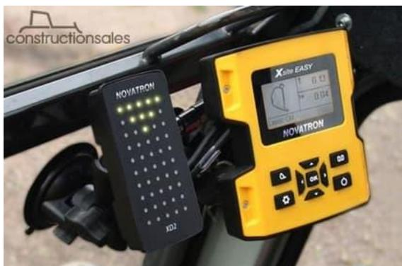
Рисунок 1.6 – Вычислительный блок Xsite Easy и светодиодное табло
