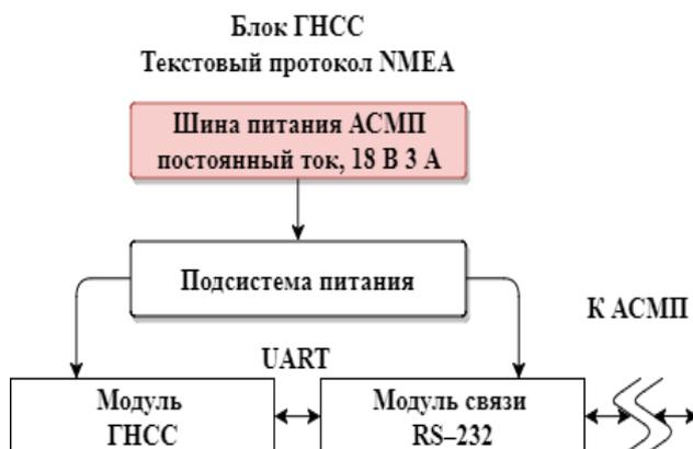
Рисунок 5 – Структура блока ГНСС с текстовым протоколом NMEA
