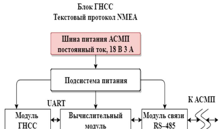
Рисунок 6 – Структура блока ГНСС с бинарным протоколом NMEA
