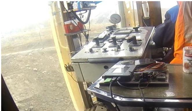
Рисунок 9 – Опытный образец АСМП в 2017 году, установленный на экскаваторе ЭШ10/50
