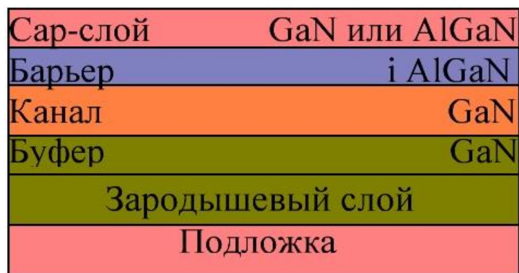
Рисунок 1.2 – Гетероструктура НЕМТ транзистора.
