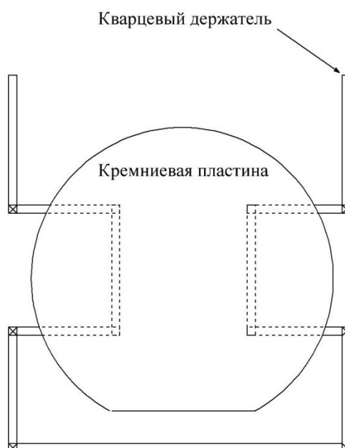
Рисунок 2.18 – Расположение кремниевой пластины на стандартном кварцевом держателе
