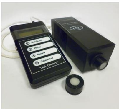
Рисунок 2.9 - Спектрофотометр ТКА-Спектр (ФАР)
