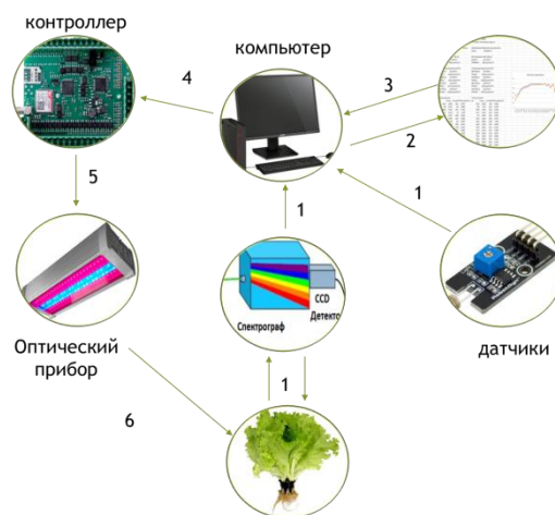
Рисунок 4 – Блок-схема реализации адаптивной оптико-электронной системы облучения
