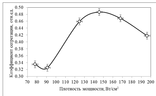
Рисунок 4.32 – Зависимость коэффициента сегрегации оксида алюминия в керамике после поверхностного электронно-лучевого спекания
