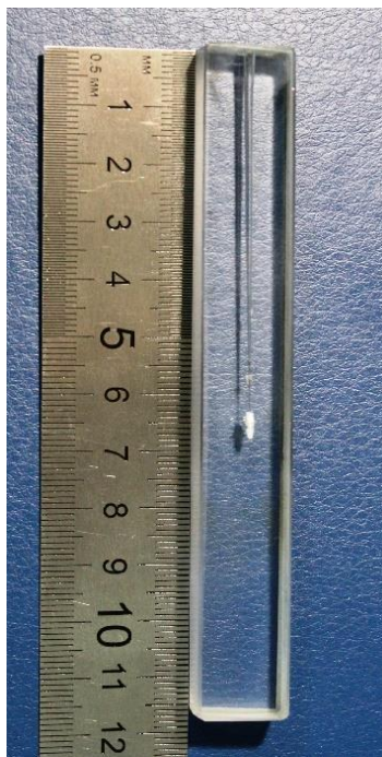
Рисунок 4.25 – Образец электронно-лучевого проплава кварцевого стекла
