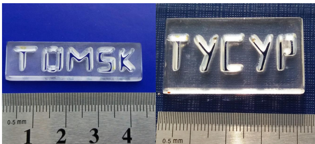
Рисунок 4.26 – Пример электронно-лучевой фрезеровки кварцевой пластины
