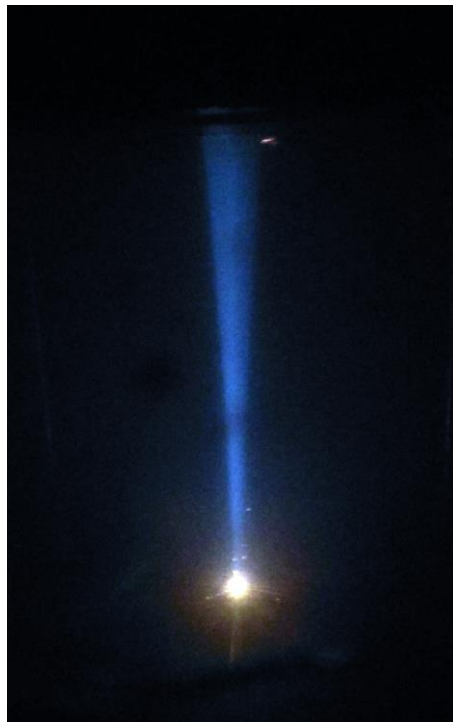
Рисунок 3.31 – Изображение электронного пучка, формируемого из пяти индивидуальных эмиссионных каналов и фокусируемого двойной фокусирующей системой
