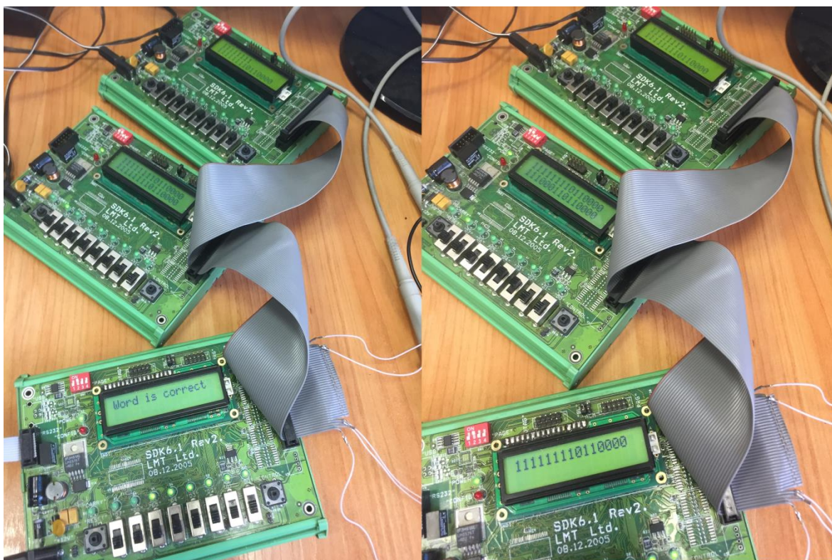
Рисунок 4.18 – Передача сообщений без ошибок (слева) и с пакетной ошибкой (справа)
