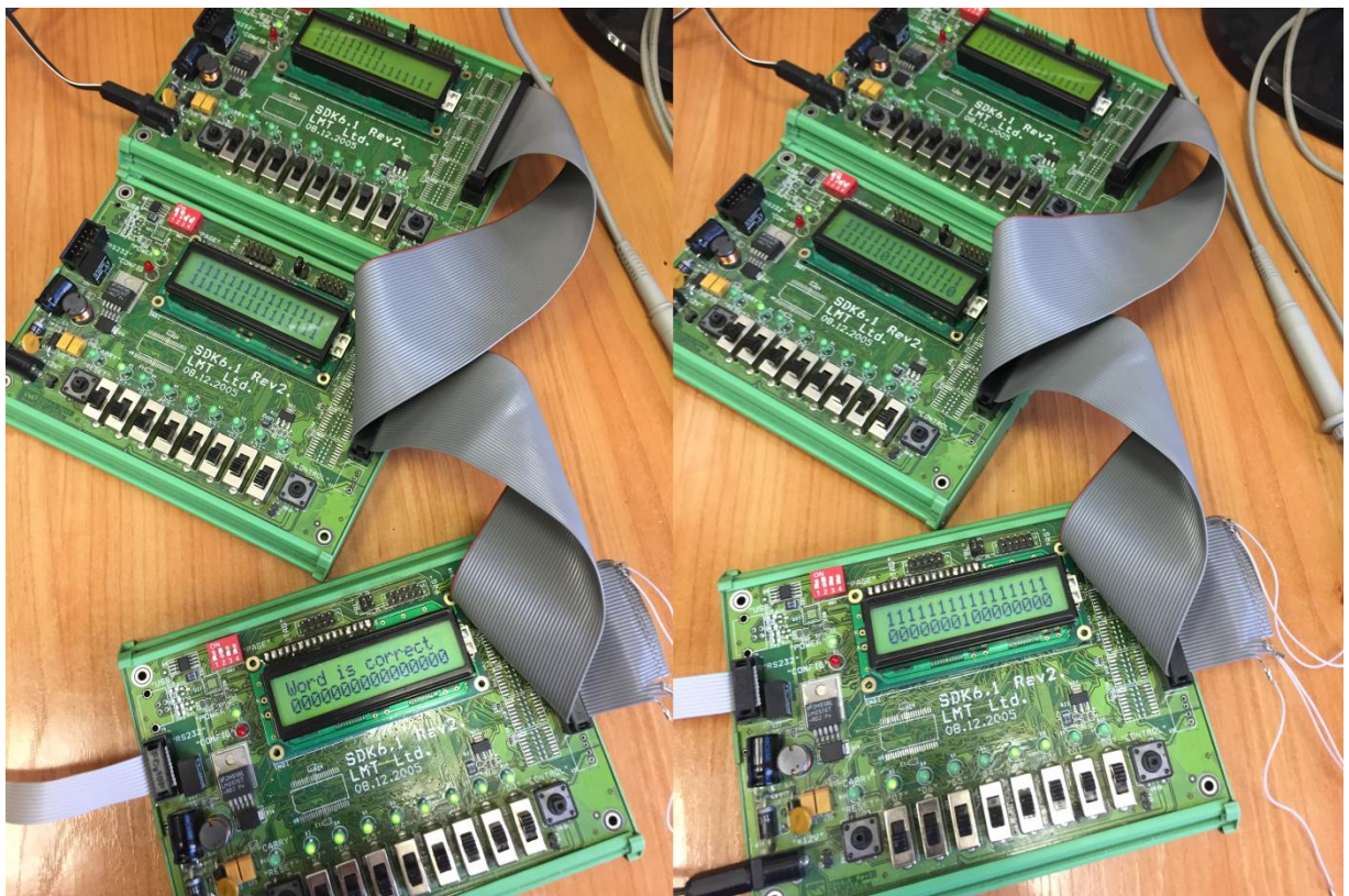
Рисунок 4.16 – Передача сообщений без ошибок (слева) и с двукратной ошибкой (справа)
