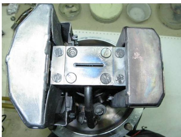
Рисунок 4.18 – Разрядная камера после работы на смеси карборана с углекислым газом. а) следы отложений на экстракционном отверстии, б) разрядная камера
