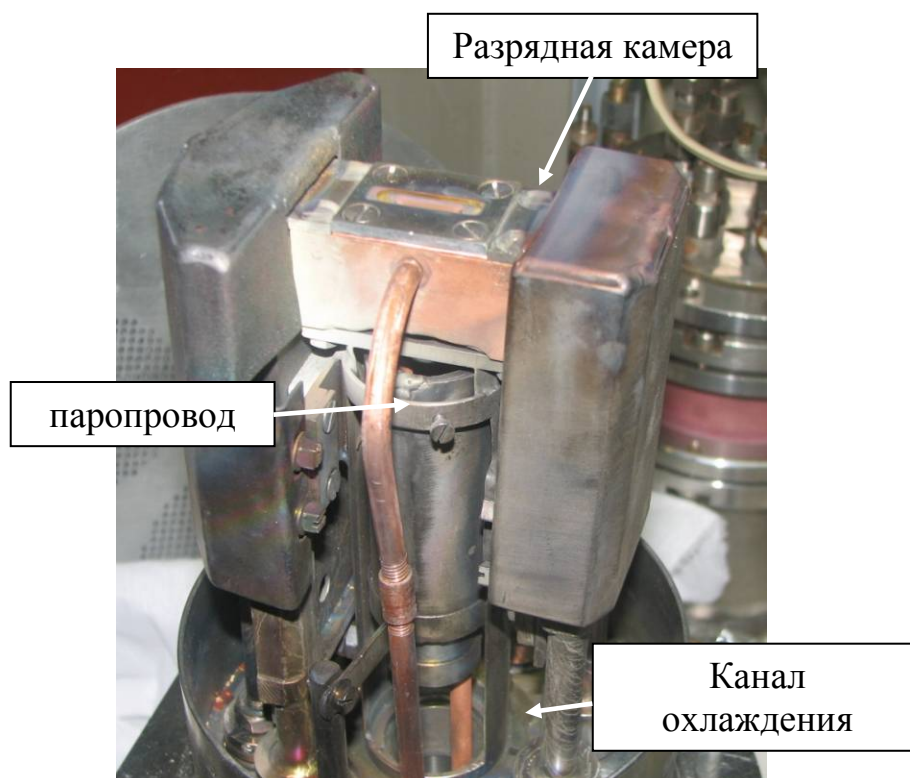
Рисунок 3.14 - Фотография источника с медной охлаждаемой разрядной камерой
