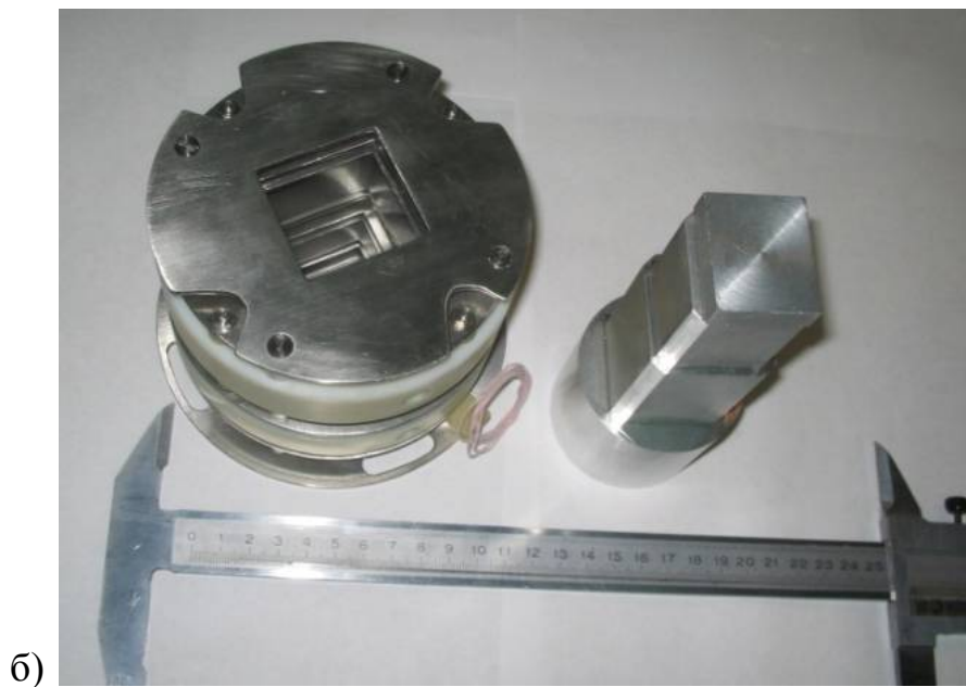
Рисунок 3.33 - Фотография изготовленного канала транспортировки многоатомного пучка ионов: а) 1 – земляной установочный электрод, 2 и 3 – потенциальные электроды, 4 – изоляторы; б) вид на канал со стороны выхода пучка и устройство юстировки канала при его сборке
