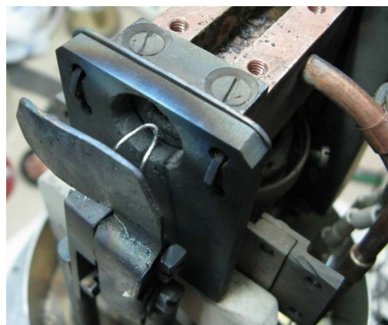
Рисунок 4.18 – Разрядная камера после работы на смеси карборана с углекислым газом. а) следы отложений на экстракционном отверстии, б) разрядная камера
