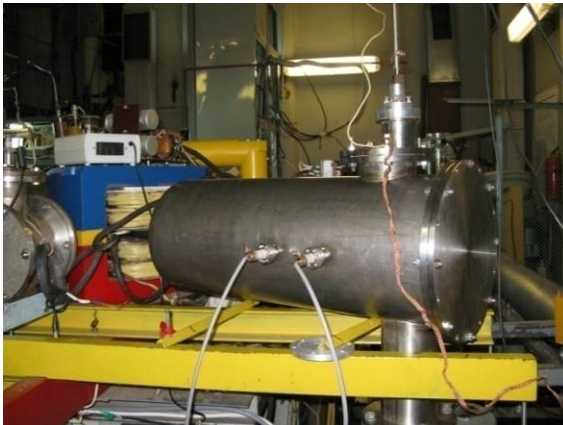
Рисунок 3.41 - Фотография канала транспортировки на основе электростатических линз, установленного на стенде УИС
