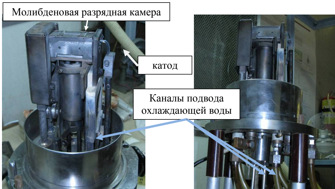
Рисунок 3.17 - Фотография ионного источника с охлаждаемой молибденовой разрядной камерой
