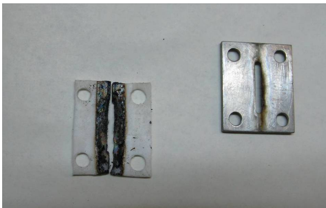
Рисунок 4.8 – Фотография поверхности фторопластовой накладки и электрода с эмиссионным отверстием после работы в течение 2 часов
