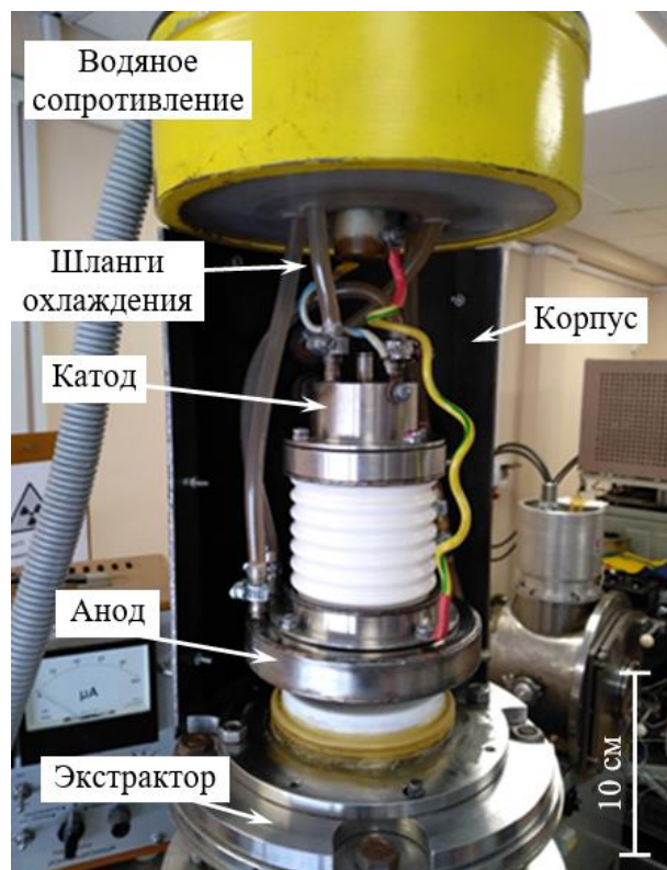
Рисунок 12 – Форвакуумный плазменный источник сфокусированного непрерывного пучка электронов: 1 – катод; 2 – анод; 3 – экстрактор; 4 – корпус фокусирующей катушки; 5 – защитный корпус; 6 – шланги водяного охлаждения, 7 – водяное сопротивление; 8 – фланец-основание; 9 – штуцеры для подключения водяного охлаждения; 10 – изолятор, предназначенный для подключения кабелей электропитания
