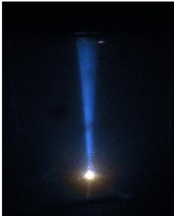
Рисунок 10 – Изображение электронного пучка, формируемого из пяти индивидуальных эмиссионных каналов и фокусируемого двойной фокусирующей системой
