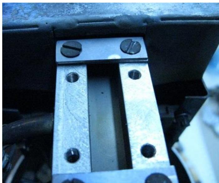
Рисунок 10 – Состояние разрядной камеры из молибдена после работы на 1,2-о-карборандикарбоновой кислоте
