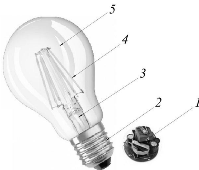
Рисунок 1.2 – Конструкция светодиодных филаментных ламп, в которых: 1-полупроводниковый понижающий преобразователь, расположенный в цоколе; 2-цоколь; 3- стеклянный держатель; 4-филамент; 5-колба, наполненная инертным газом
