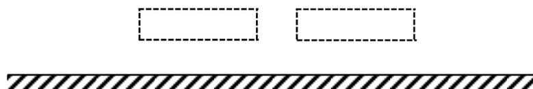
Рисунок 5.22 – Два проводника над идеально проводящей плоскостью
