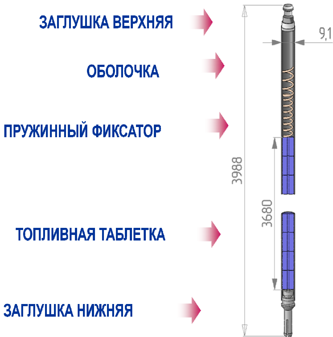
Рисунок 1.2 – Общий вид твэла реактора ВВЭР-1000 типа ТВС-2М
