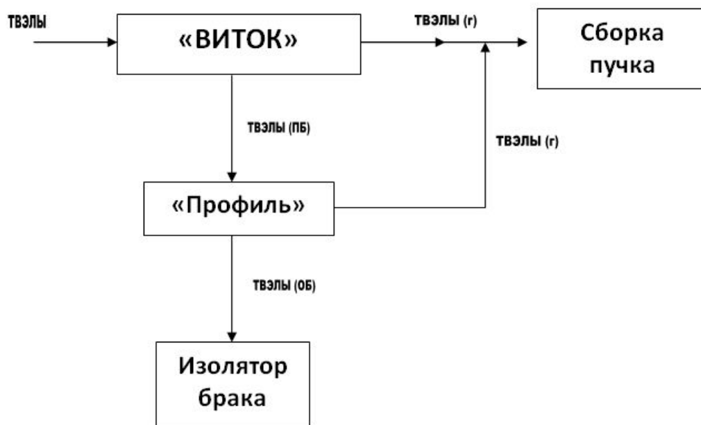
Рисунок 4.19 - Схема комплексного контроля твэлов ВВЭР-1000 дефектов наружной поверхности
