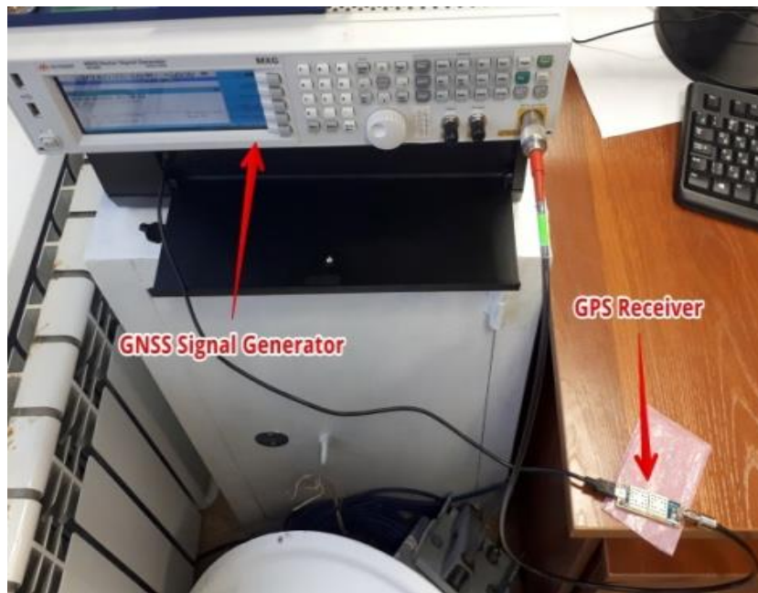
Рисунок 4.2. Вид экспериментального лабораторного макета: генератор навигационных сигналов и GPS/Galileo приемник
