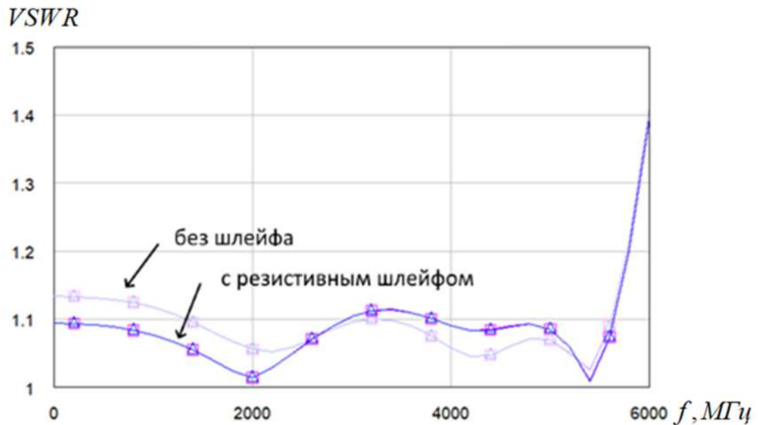
Рисунок 4.6 - График частотной зависимости VSWR аттенюатора с симметрично расположенными заземленными резистивными шлейфами
