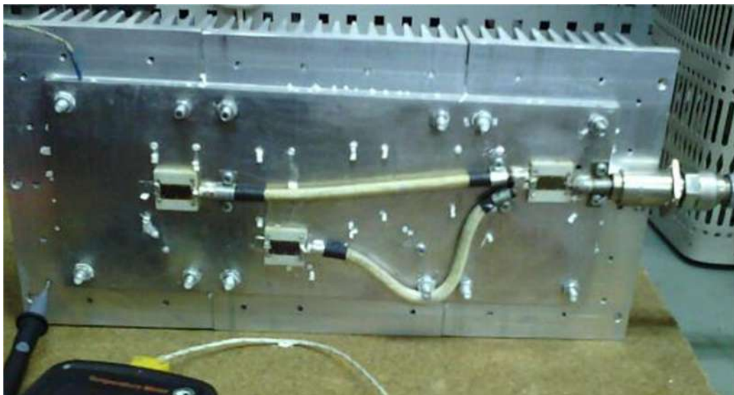
Рисунок 5.12 – Экспериментальный макет трёхэлементной нагрузки 600 Вт (рабочий диапазон частот 0 - 1 ГГц)
