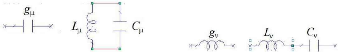
Рисунок 3.2 – Преобразования реактивных элементов ФНЧ в колебательные контура
