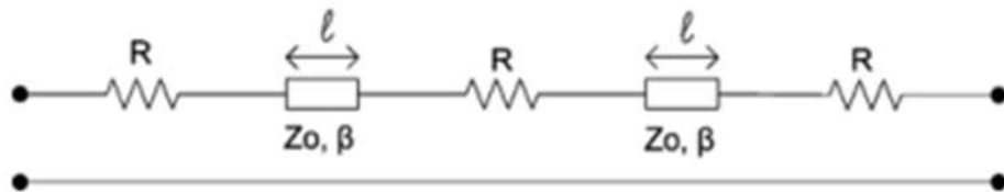
Рисунок 1.9 – Структурная схема трёхэлементного аттенюатора на пленочных резисторах
