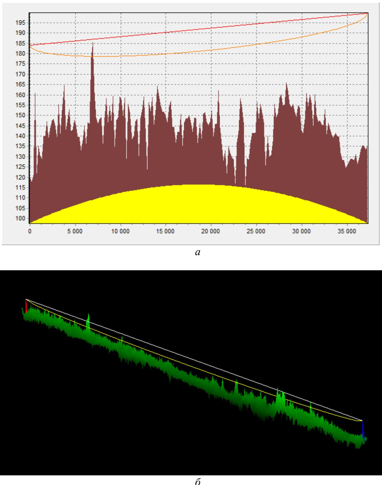
Рисунок 2.7 – Продольный профиль пролета В-С с учетом рельефа и подстилающей поверхности местности (*a*) и трёхмерная модель пролета В-С (*б*)
