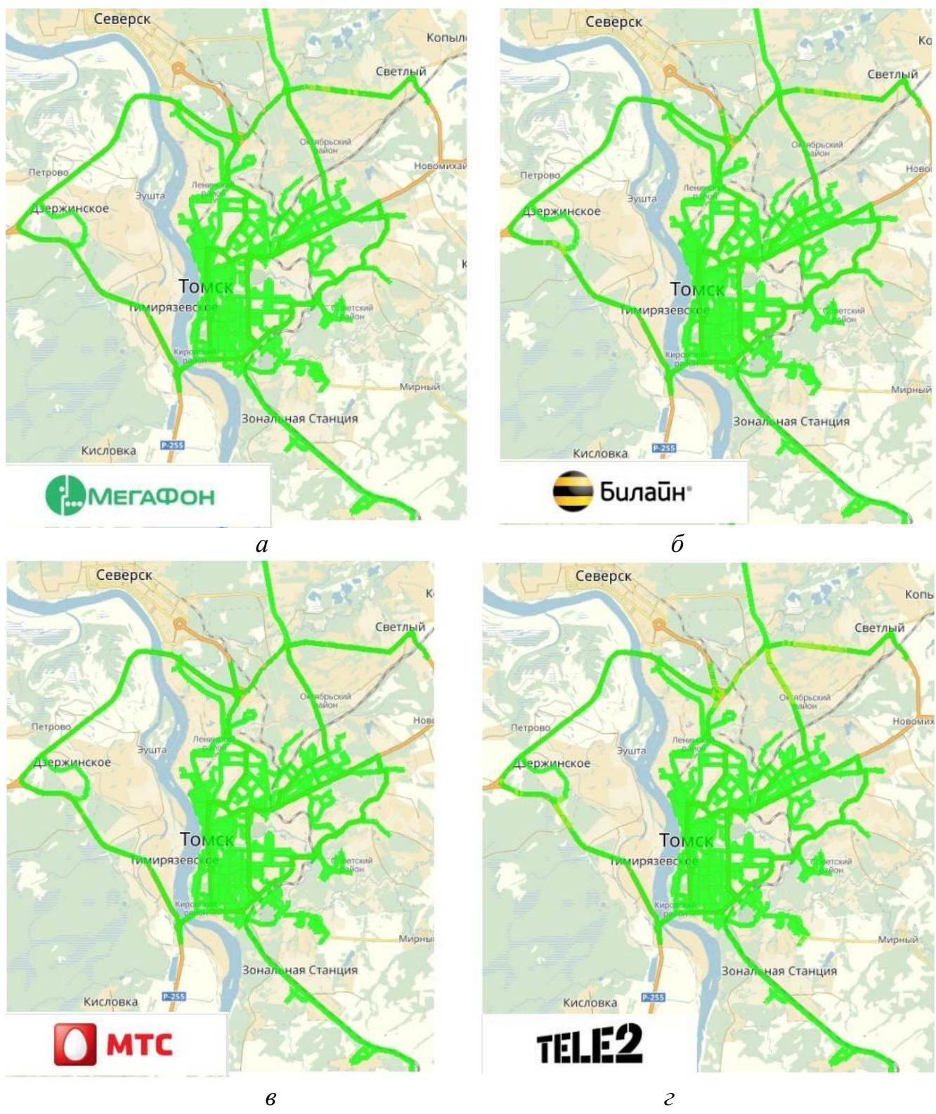
Рисунок 3.6 – Графическое отображение данных о качестве покрытия в сетях связи Megafon (*а*), Beeline (*б*), MTS (*в*), Tele2 (*г*) стандарта GSM900/1800
