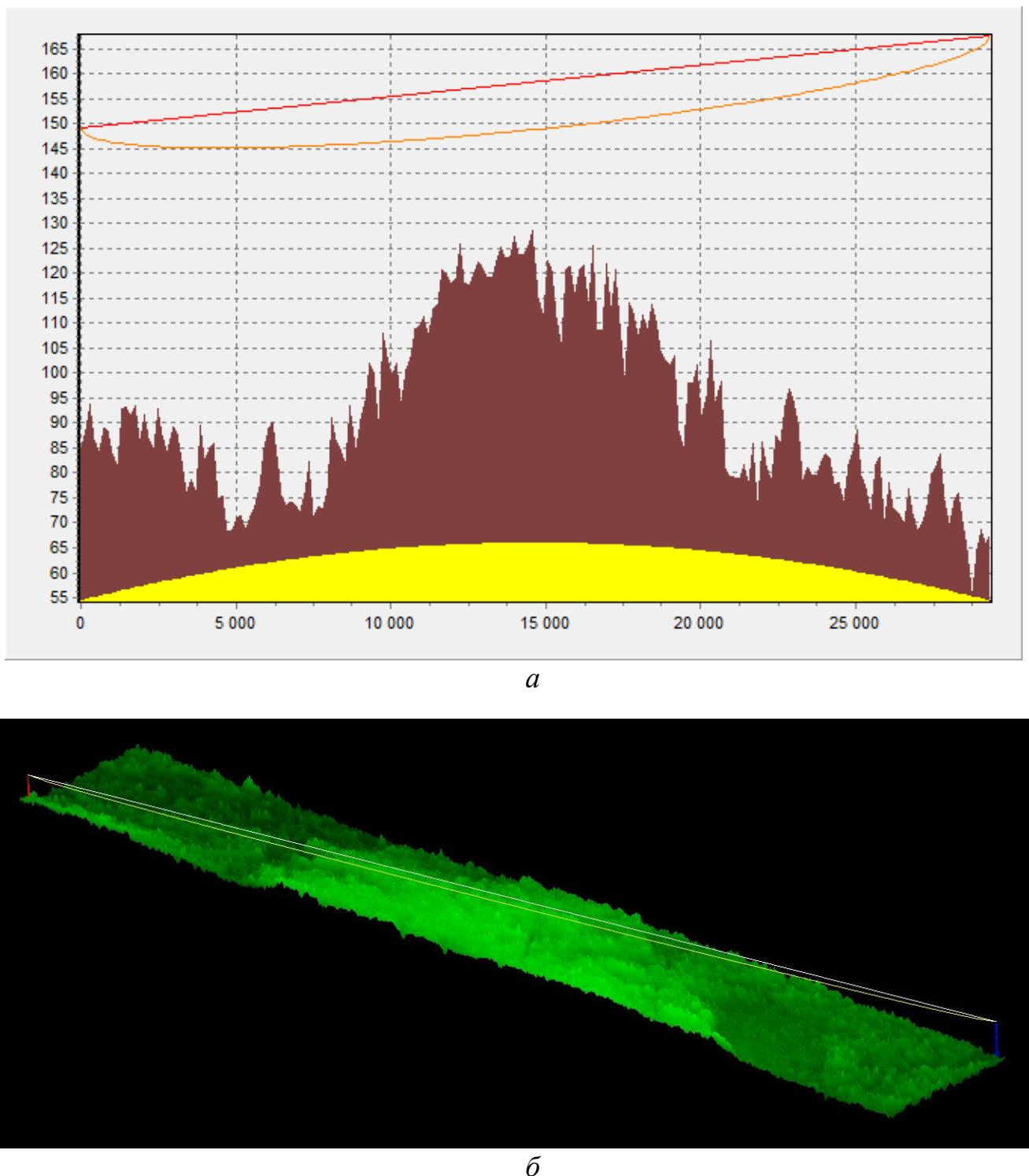
Рисунок 2.16 – Продольный профиль пролета К-Л с учетом рельефа и подстилающей поверхности местности (*a*) и трёхмерная модель пролета К-Л (*б*)
