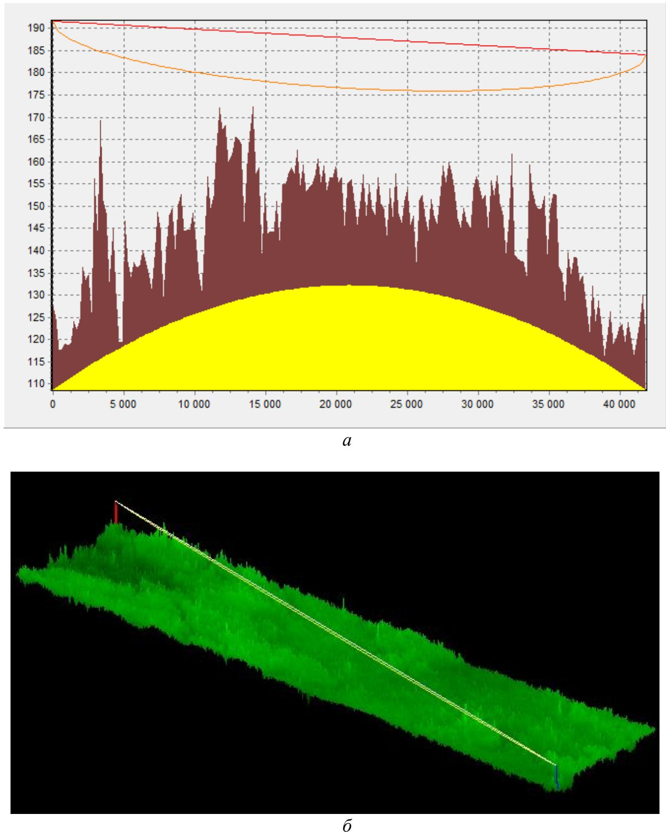
Рисунок 2.6 – Продольный профиль пролета А-В с учетом рельефа и подстилающей поверхности местности (*a*) и трёхмерная модель пролета А-В (*б*)
