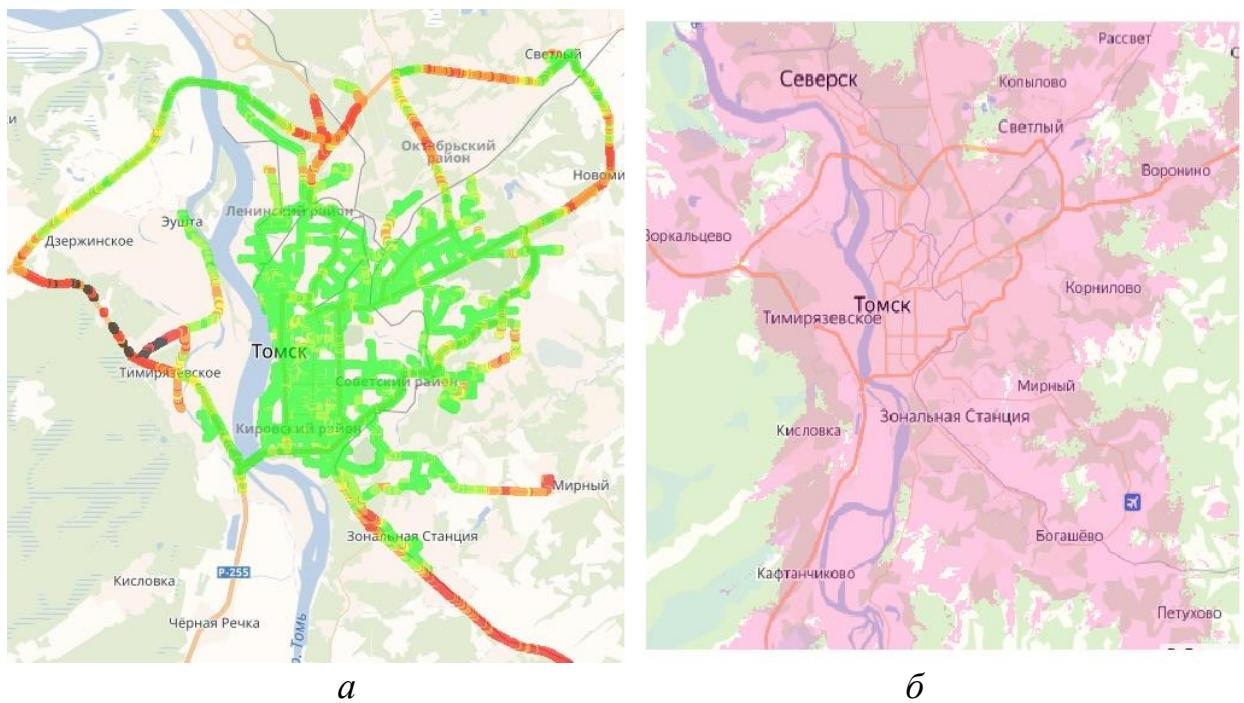
Рисунок 3.16 – Сравнение данных о покрытии сетью 3G оператора Tele2 по результатам измерений в 2018 г. (а) и данным на сайте оператора (б)
