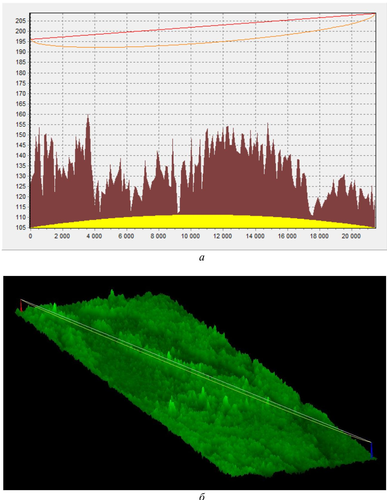
Рисунок 2.13 – Продольный профиль пролета Н-І с учетом рельефа и подстилающей поверхности местности (*а*) и трёхмерная модель пролета Н-І (*б*)
