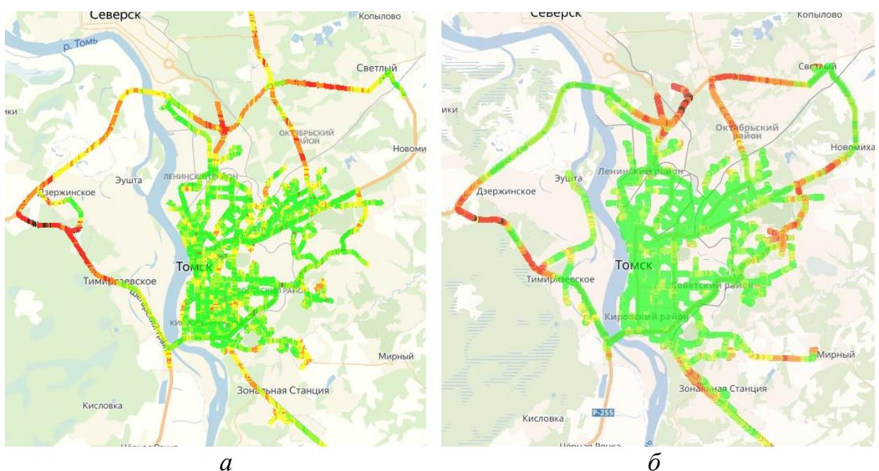
Рисунок 3.8 – Сравнение данных о покрытии сетью 3G оператора Megafon по результатам измерений в 2016 (*а*) и 2018 (*б*) гг.
