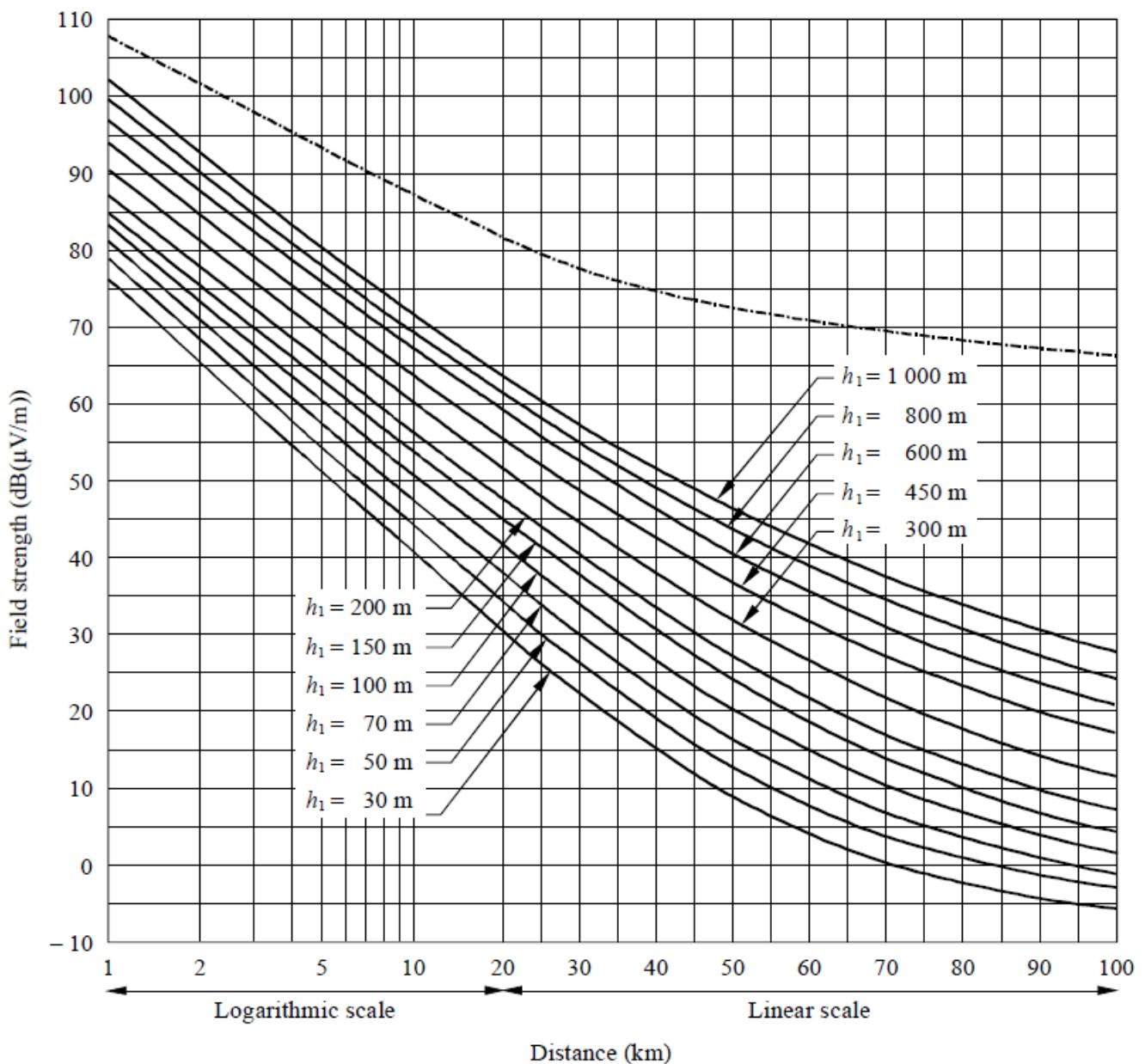
Рисунок 1.7 – Семейство кривых для определения напряженности поля в зависимости от расстояния для частот в окрестности 450 МГц согласно рекомендации МСЭ-R P.529, 50% времени
