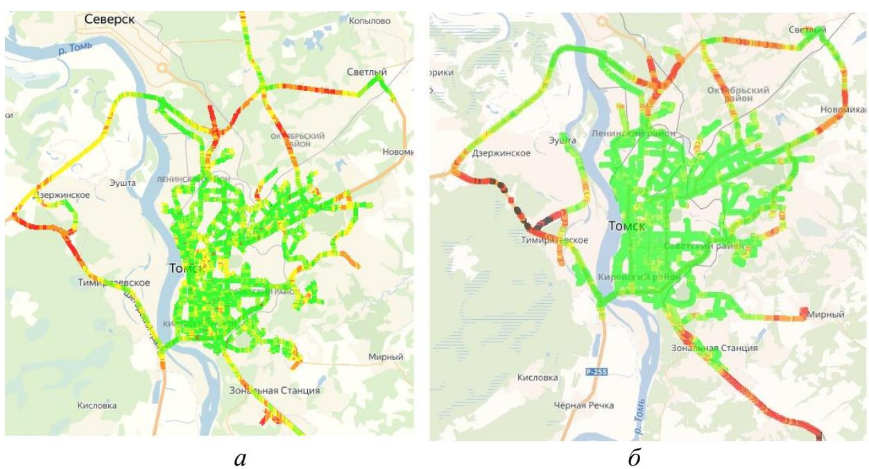
Рисунок 3.10 – Сравнение данных о покрытии сетью 3G оператора Tele2 по результатам измерений в 2016 (*а*) и 2018 (*б*) гг.
