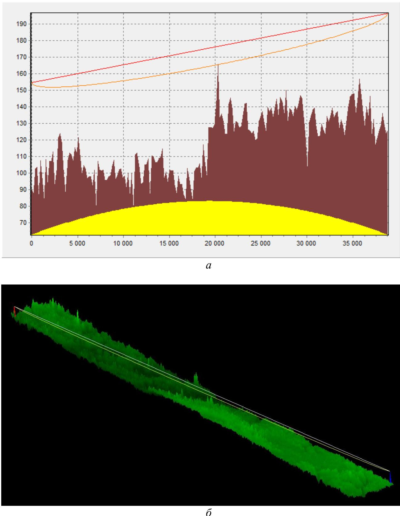
Рисунок 2.12 – Продольный профиль пролета G-H с учетом рельефа и подстилающей поверхности местности (а) и трёхмерная модель пролета G-H (б)
