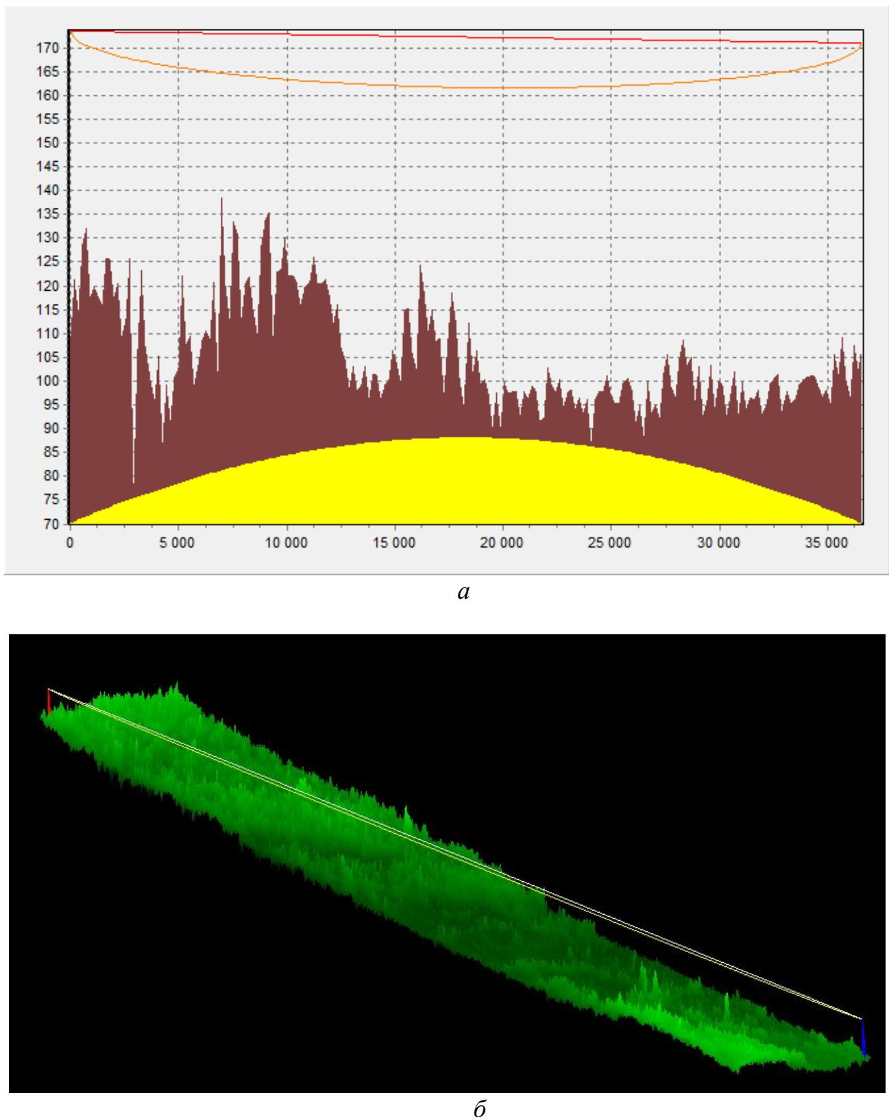
Рисунок 2.9 – Продольный профиль пролета D-E с учетом рельефа и подстилающей поверхности местности (*a*) и трёхмерная модель пролета D-E (*б*)
