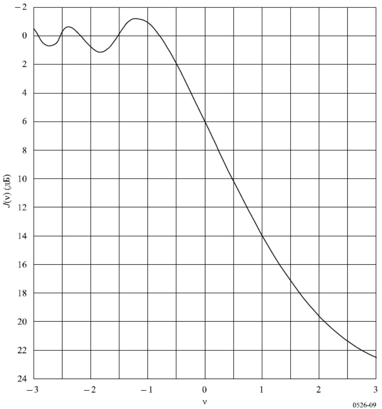
Рисунок 1.6 – Зависимость дифракционных потерь на клиновидном препятствии в соответствии с рекомендацией МСЭ-R Р.526 от параметра  $v$
