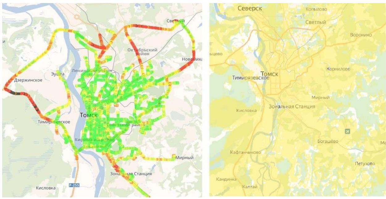
Рисунок 3.13 – Сравнение данных о покрытии сетью 3G оператора Beeline по результатам измерений в 2018 г. (а) и данным на сайте оператора (б)
