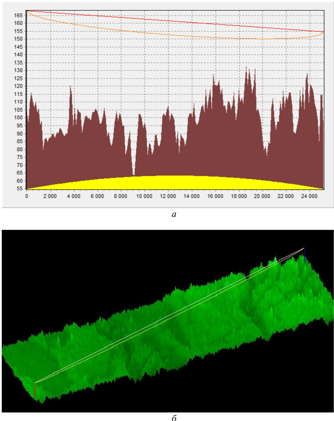
Рисунок 2.11 – Продольный профиль пролета F-G с учетом рельефа и подстилающей поверхности местности (*a*) и трёхмерная модель пролета F-G (*б*)
