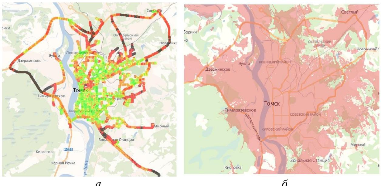
Рисунок 3.19 – Сравнение данных о покрытии сетью 4G оператора MTS по результатам измерений в 2018 г. (*a*) и данным на сайте оператора (*б*)
