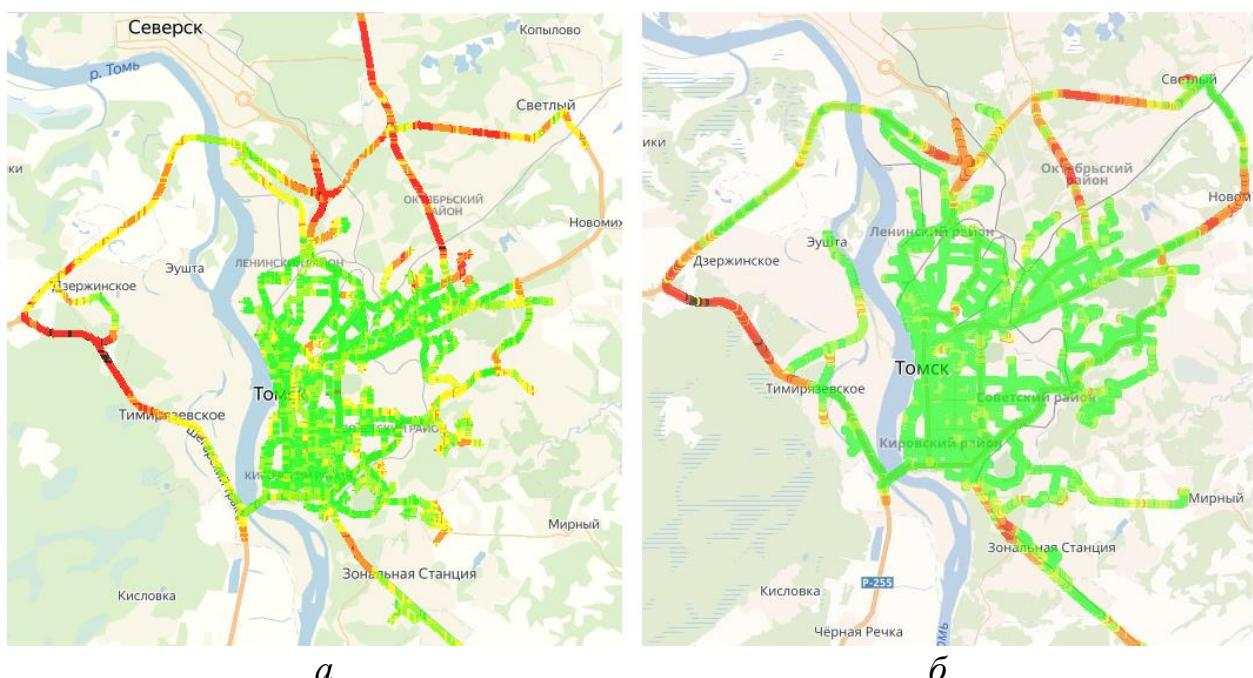
Рисунок 3.9 – Сравнение данных о покрытии сетью 3G оператора MTS по результатам измерений в 2016 (*а*) и 2018 (*б*) гг.
