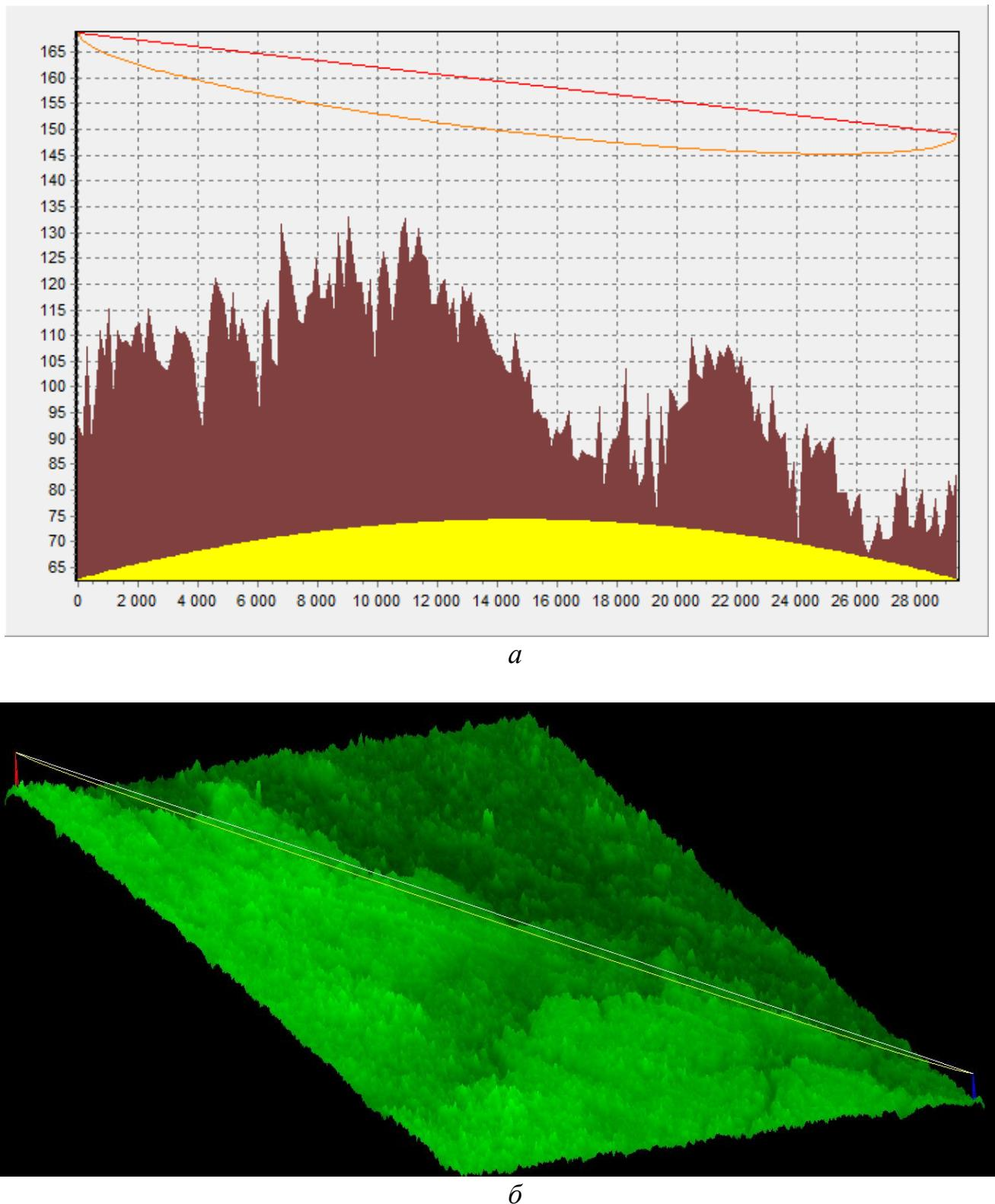
Рисунок 2.15 – Продольный профиль пролета J-K с учетом рельефа и подстилающей поверхности местности (*a*) и трёхмерная модель пролета J-K (*б*)
