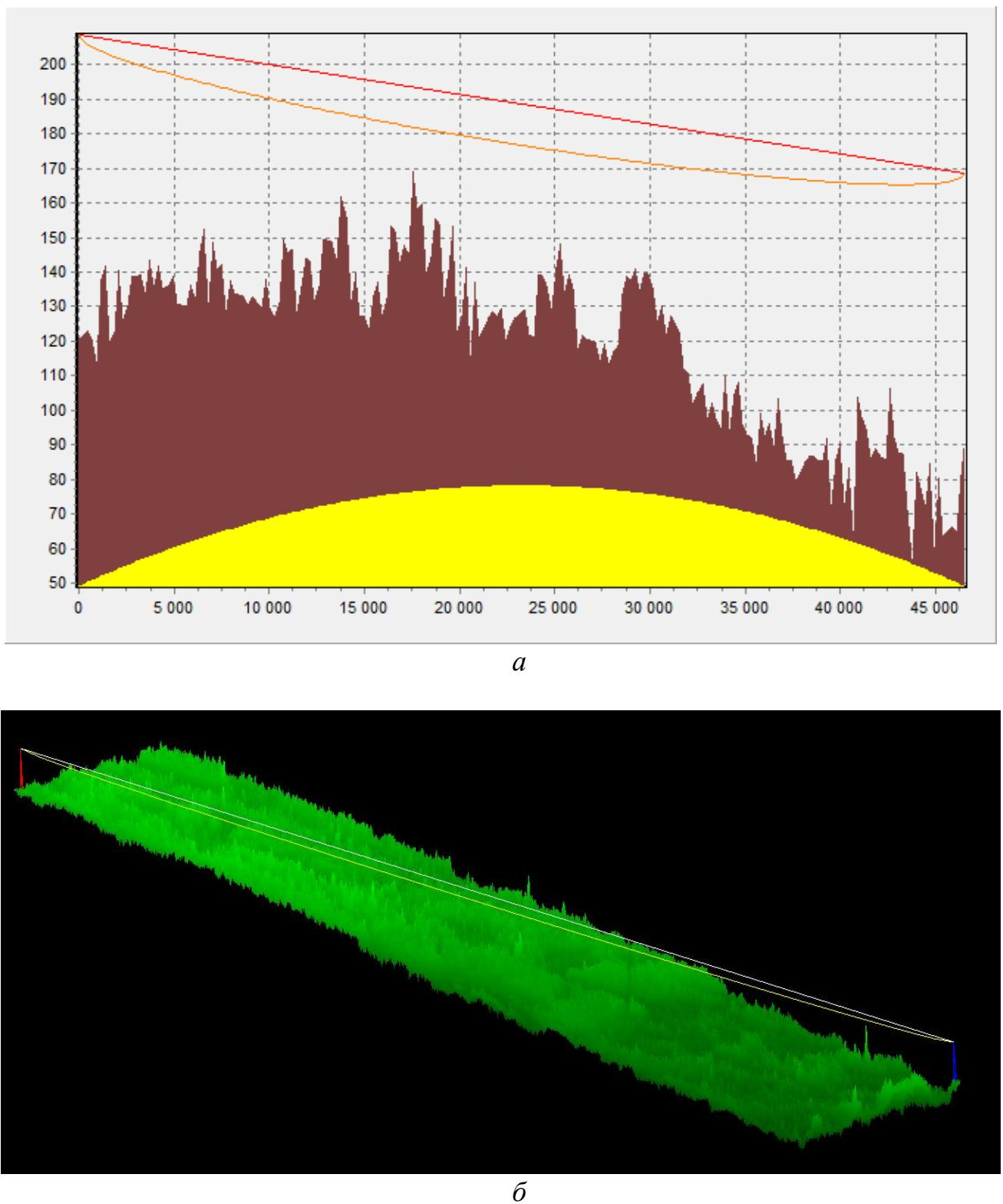
Рисунок 2.14 – Продольный профиль пролета I-J с учетом рельефа и подстилающей поверхности местности (*a*) и трёхмерная модель пролета I-J (*б*)
