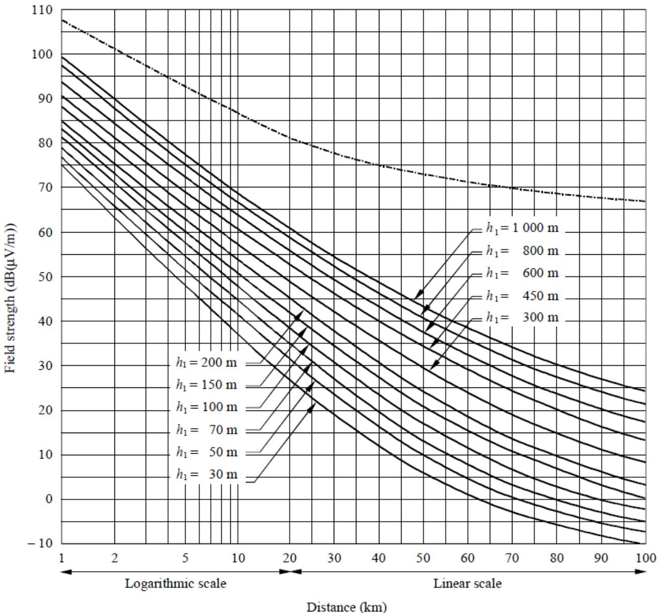
Рисунок 1.8 – Семейство кривых для определения напряженности поля в зависимости от расстояния для частот в окрестности 900 МГц согласно рекомендации МСЭ-R Р.529, 50% времени
