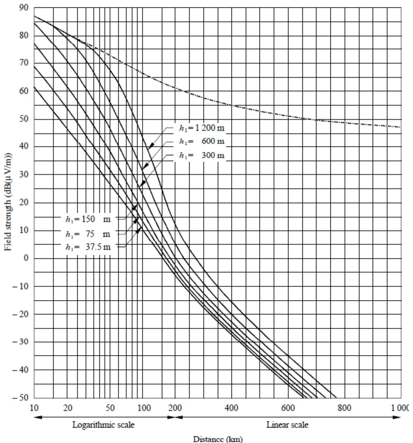
Рисунок 1.3 – Семейство кривых для определения напряженности поля в зависимости от расстояния для диапазона 450–1000 МГц согласно рекомендации МСЭ-R Р.370, 50% времени
