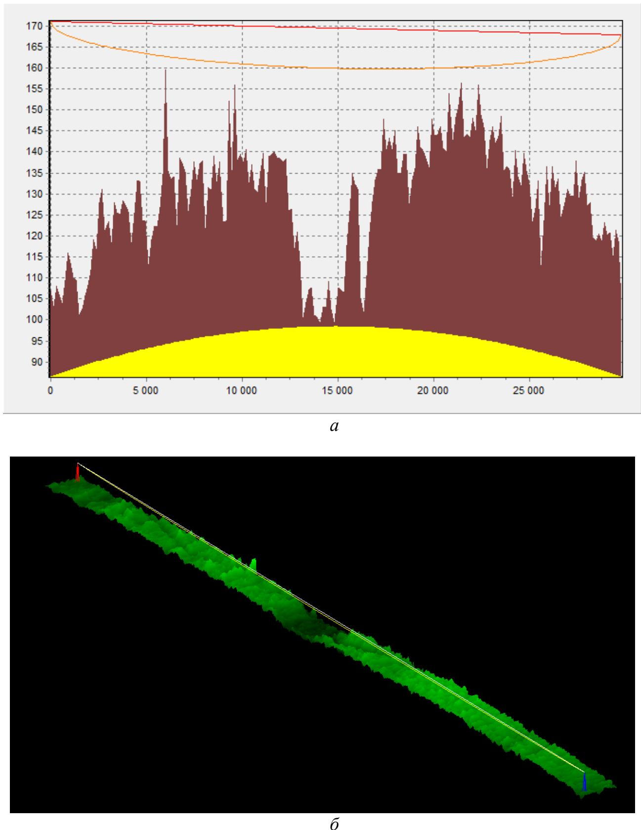
Рисунок 2.10 – Продольный профиль пролета Е-Ф с учетом рельефа и подстилающей поверхности местности (*a*) и трёхмерная модель пролета Е-Ф (*б*)
