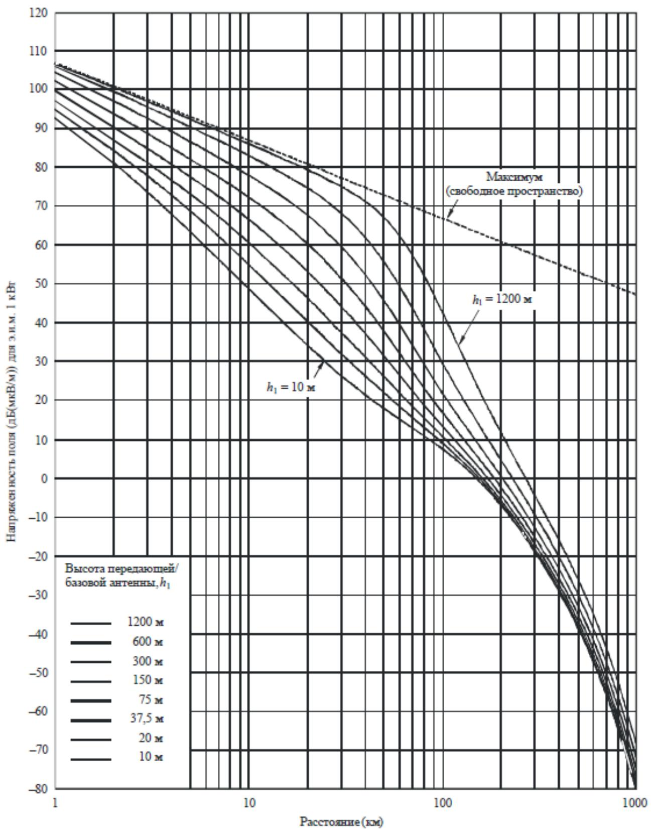
Рисунок 1.9 – Семейство кривых для определения напряженности поля в зависимости от расстояния для частот в окрестности 600 МГц согласно рекомендации МСЭ-R Р.1546, 50% времени
