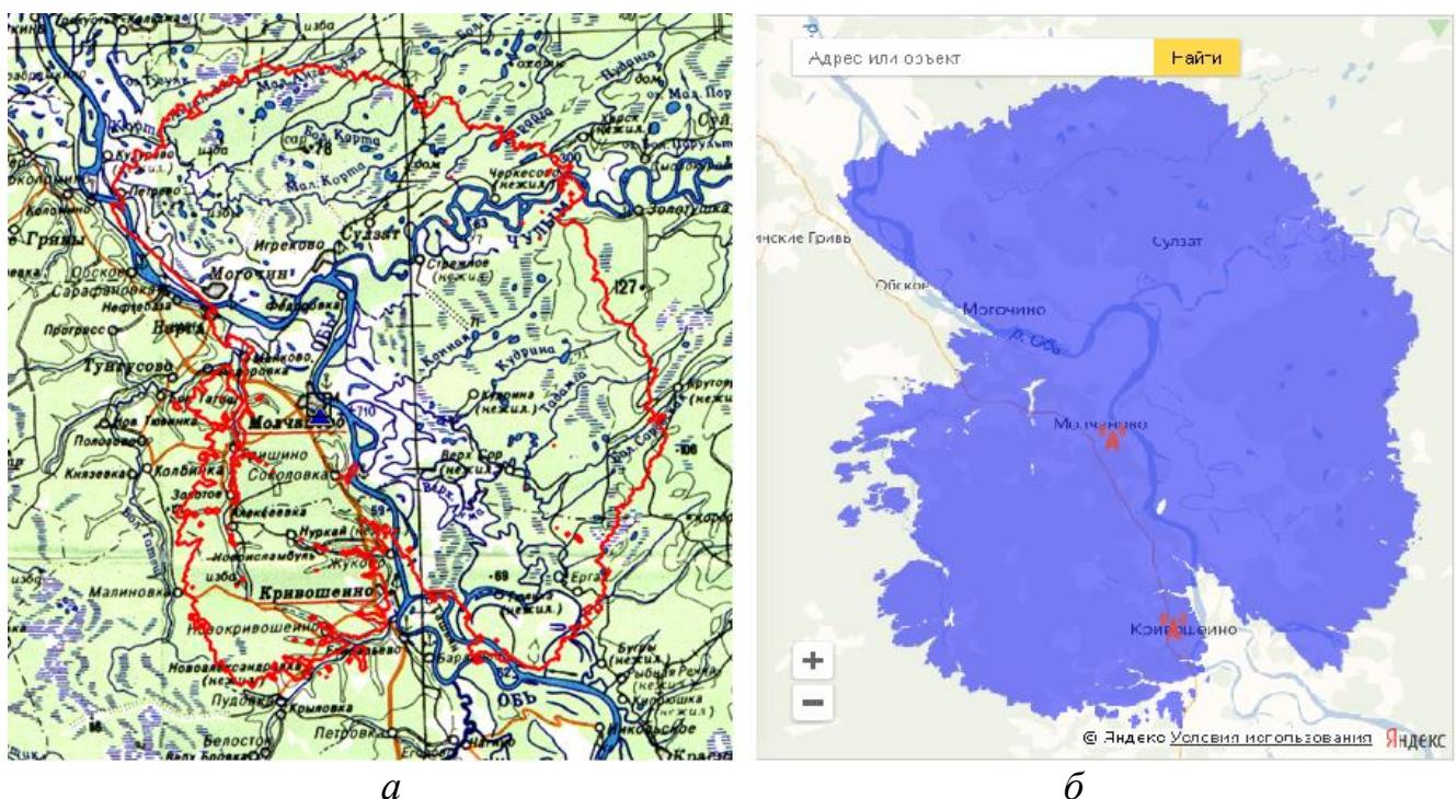
Рисунок 1.2 – Скриншот расчета зоны покрытия для цифрового телевизионного передатчика в с. Молчаново Томской области с помощью ПИАР 4.60 (а) и данные о зоне покрытия этого передатчика с сайта РТПС (б)
