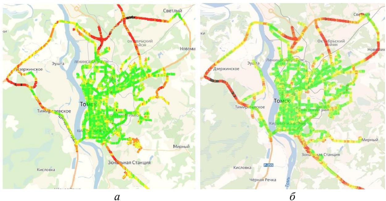
Рисунок 3.7 – Сравнение данных о покрытии сетью 3G оператора Beeline по результатам измерений в 2016 (*а*) и 2018 (*б*) гг.
