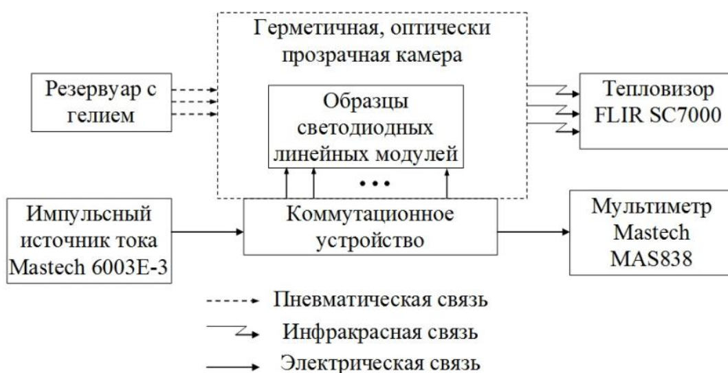
Рисунок 3.17 – Структурная схема измерительной установки
