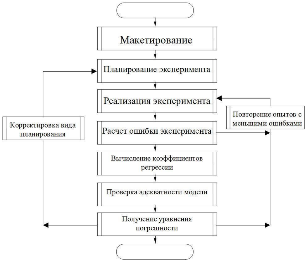
Рисунок 2.11 – Общий алгоритм определения коэффициентов весоности, базирующийся на проектировании эксперимента
