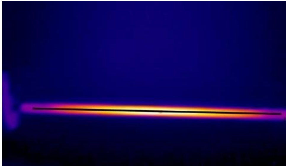
Рисунок 3.20 – Температурное поле ФСНМ с люминофорным покрытием
