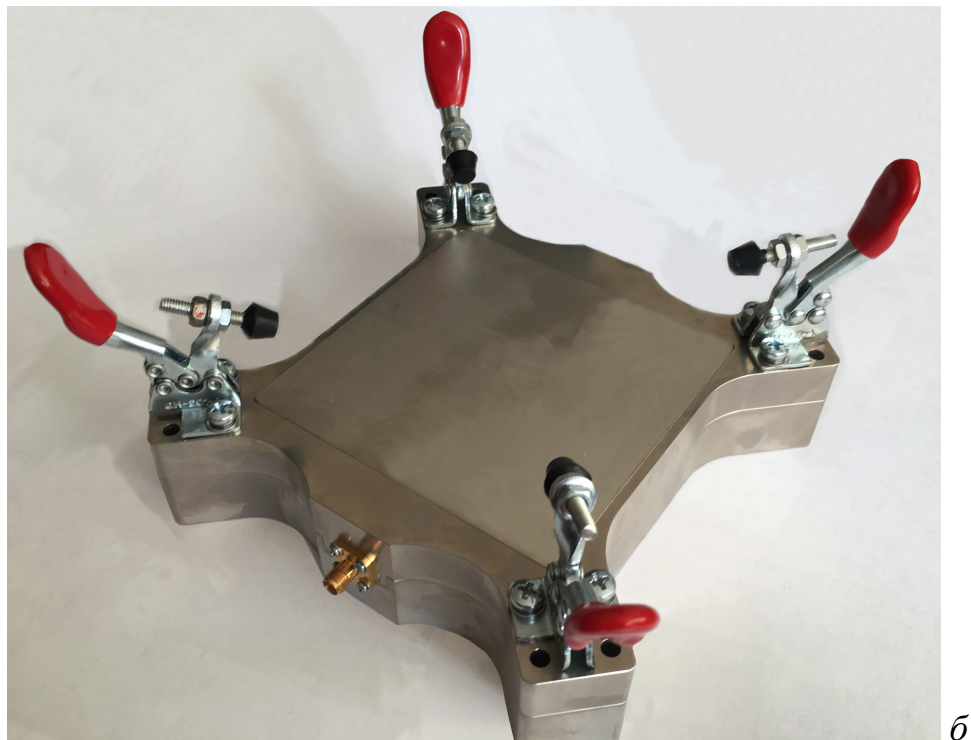
Рисунок 2.16 – Лабораторный макет ТЕМ-камер с открытой апертурой ( а ) и испытательным столом ( б )
