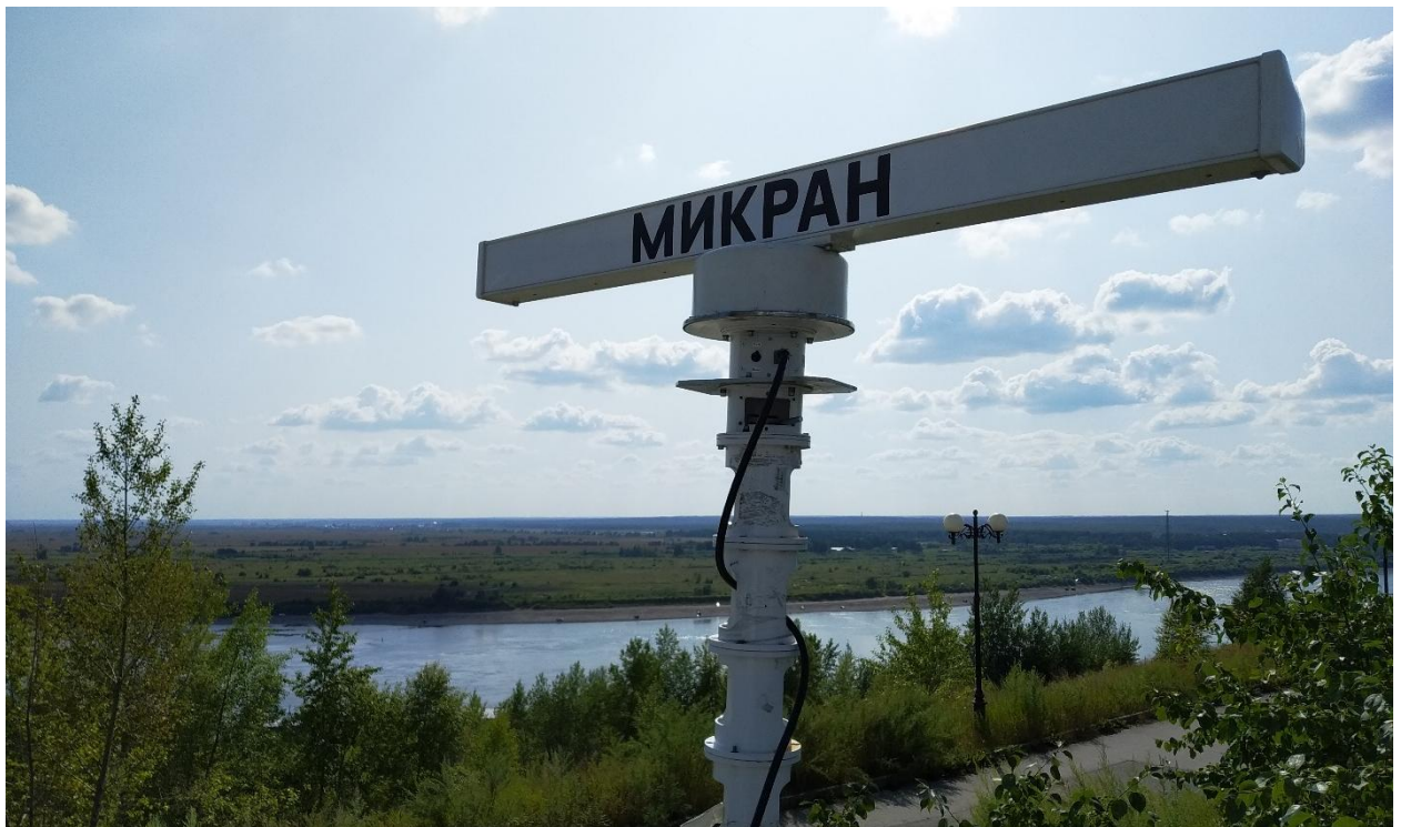
Рисунок 3.2 – Фотография: РЛС «MRS-1000» на испытании фонового метода.
