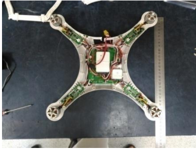
а) – вид сверху квадрокоптера Cheerson-CX-20 без верхней крышки (габариты (283×281× 200) мм)
