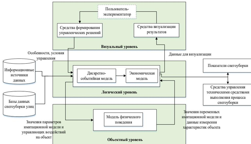
Рисунок 3 – Структурно-функциональная схема многоуровневых имитационных моделей процесса снегоуборки
