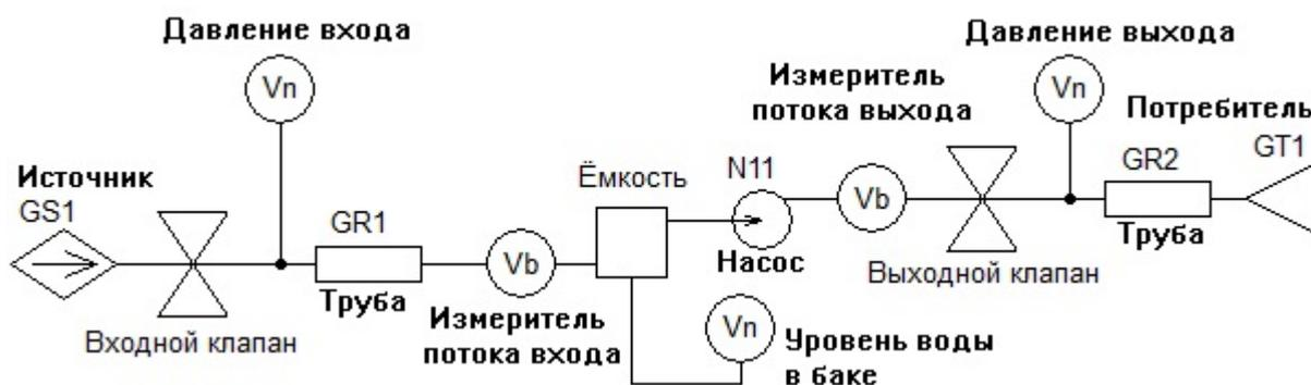
Рисунок А.27 – КЦ системы гидрополива на С-слое
