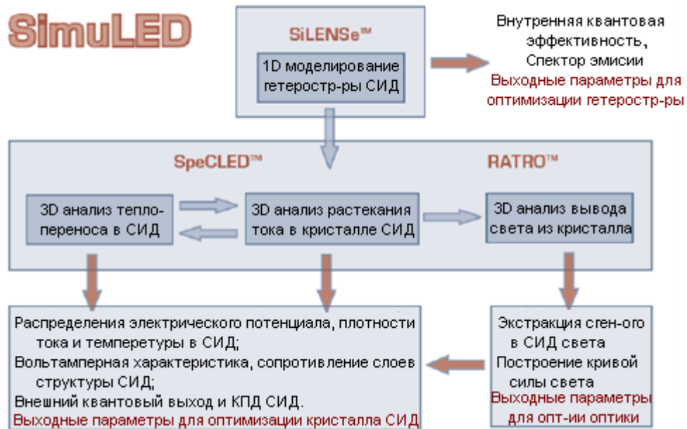
Рисунок 4.16 – Структурная схема среды SimuLED
