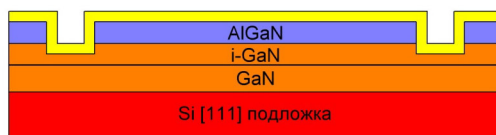
Рисунок 2.2 – Схематическое изображение последовательности операций формирования тестовых структур ОК
