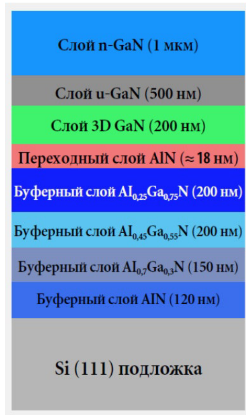
Рисунок 1.16 – Пример введения переходных слоев на подложке из кремния от компании OMMIC [94]
