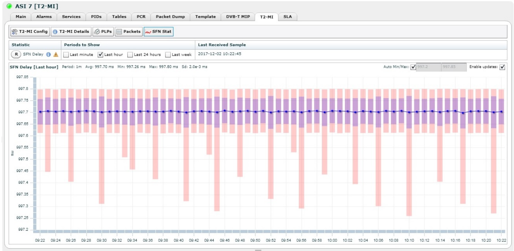
Рисунок Б.16 – Снимок экрана компьютера с изображением WEB интерфейса анализатора TNS-546 при синхронизации его с помощью опорного сигнала приёмника GPS/ГЛОНАСС. График сетевой задержки представлен во временном интервале, равном одному часу.
