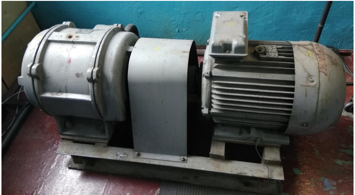
Рисунок 4.14 – Экспериментальная установка: а – экспериментальный образец СУ УШГН; б – БУ-НС; в – нагрузка СУ УШГН
