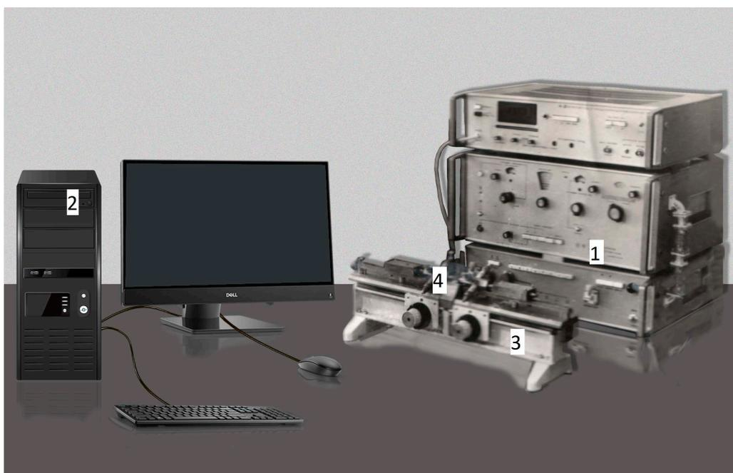
Рисунок 4.1 – Общий вид двухпортового четырехзондового ЦАЦ
