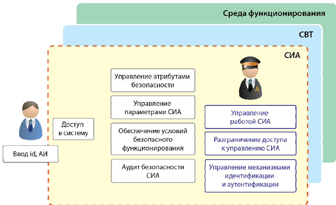
Рисунок 3.3 – Типовая функциональная схема клиентской части СИА
