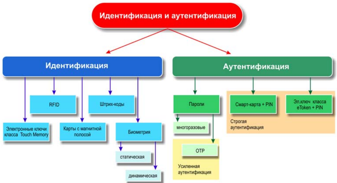
Рисунок 3.8 – Классификация средств идентификации и аутентификации в зависимости от применяемых технологий
