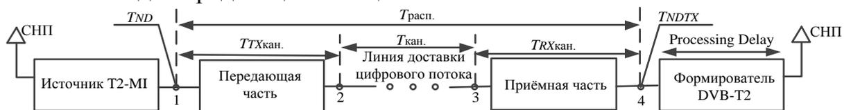
Рисунок 4 – Схема распространения цифрового потока
