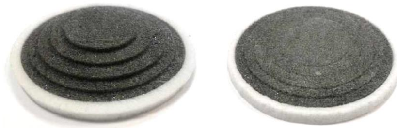
Рисунок 12 — Изготовление плоской линзы Лüneберга из слоёв диэлектрика различной плотности
