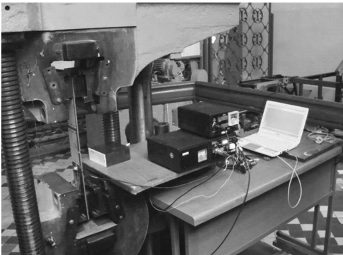
Рисунок 4.5 Общий вид экспериментальной установки для испытаний на разрыв, разрывная машина ГСМ-50 и комплект ДИАД
