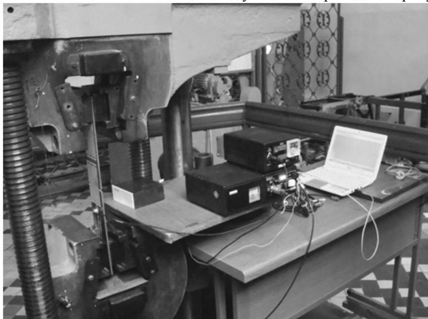
Рисунок 4.1 Общий вид экспериментальной установки для испытаний на разрыв, разрывная машина ГСМ-50 и комплект ДИАД
