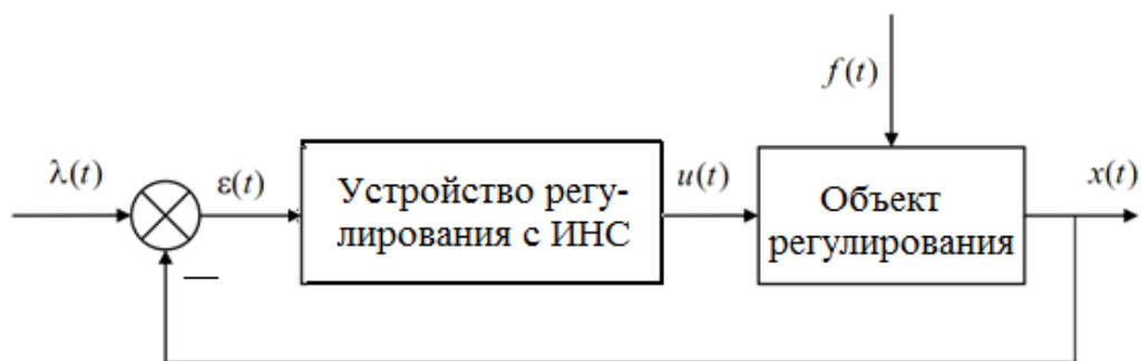
Рисунок 2.1.1 – Автоматическая система регулирования
