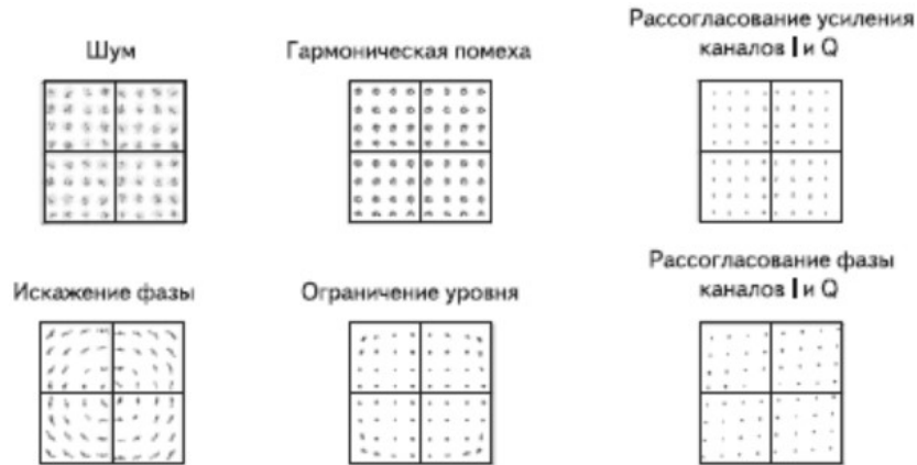
Рисунок 2.17 — искажения при QAM модуляции
