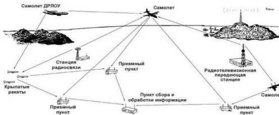
Рисунок 1.6 - Принцип действия МРЛС «СайлентСентри»
