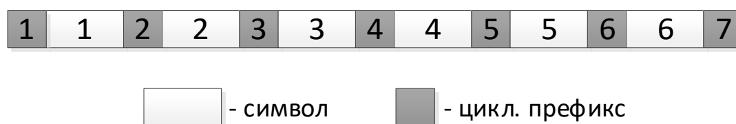
Рисунок 3.11 – Последовательность символов в системе CP-OFDM
