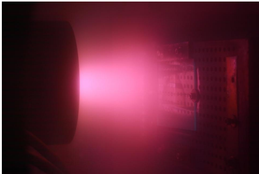
Рисунок 4.67 – Схема эксперимента для генерации борсодержащей плазмы и осаждения покрытий (вверху) и фотография работы магнетрона (внизу).
