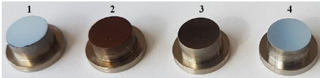
Рисунок 4.13 – Образцы из титана с полученными покрытиями на основе керамики. Параметры экспериментов: 1 – p=6,9 кВт/см 2 ; 2 – p=7,2 кВт/см 2 ; 3 – p=7,6 кВт/см 2 ; 4 – p=7,0 кВт/см 2 ; давление во всех экспериментах 5 Па
