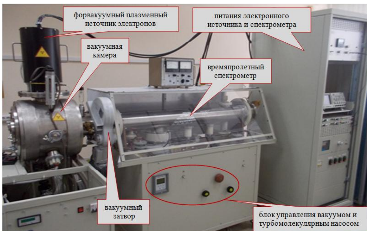
Рисунок 2.24 – Экспериментальная установка, оснащенная времяпролетным спектрометром
