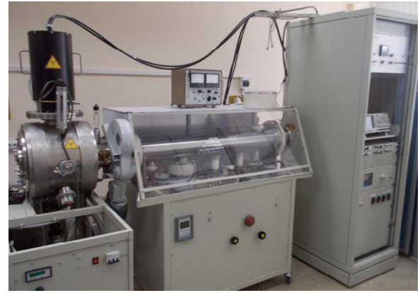
Рисунок 3 – Схема (справа) и внешний вид (слева) экспериментальной установки с обращенным времяпролетным спектрометром:
