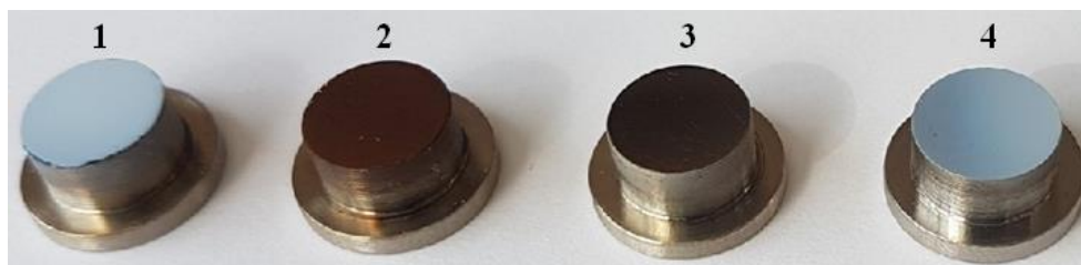
Рисунок 12 – Образцы из титана с полученными покрытиями на основе керамики при плотности мощности: 1 – 6,9 \text{ кВт/см}^2 ; 2 – 7,2 \text{ кВт/см}^2 ; 3 – 7,6 \text{ кВт/см}^2 ; 4 – 7,0 \text{ кВт/см}^2
