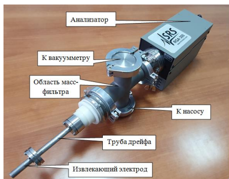
Рисунок 5 – Фотография масс-спектрометра на основе модернизированного анализатора RGA-300 и масс-спектры ионов пучковой плазмы при испарении алюмооксидной керамики
