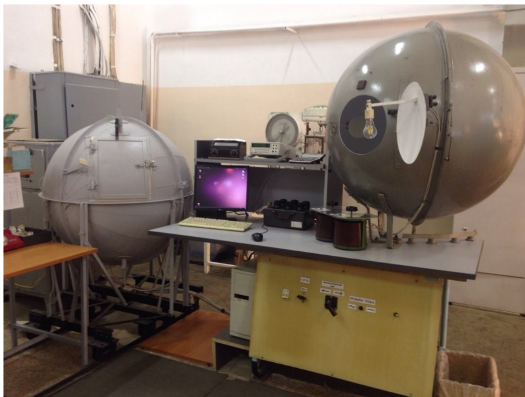
Рисунок 3.11 – Оборудование для измерения светового потока ламп
