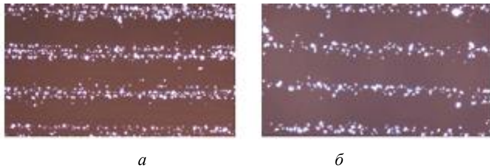
Рисунок 1.16 – Микрофотография ансамбля частиц \text{CaCO}_3 ( d \sim 1-3 мкм), осажденных в суспензии гексана на поверхность волновода, полученного внедрением ионов фтора с энергией 30 МэВ, после воздействия интерференционной картины с периодом \Lambda = 65 мкм в течение 30 с ( a ) и 3 с ( б ) [24]
