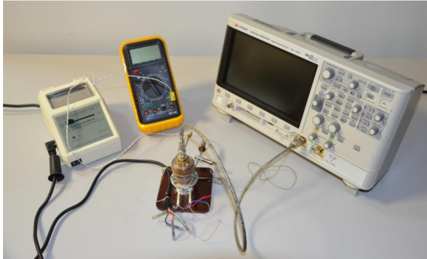
Рисунок 5.13 – Внешний вид установки для исследования динамики пьезоэлектрической генерации
