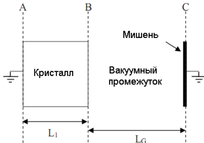
Рисунок 1.5 – Схема пьезоэлектрического генератора с одним кристаллом [10]
