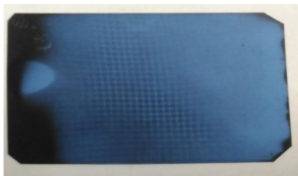
Рисунок 5.6 – Рентгеновское изображение сетки 12 (толщина 0,3 мм, размер ячейки 1×1 мм), полученное с использованием цилиндрического образца \text{LiNbO}_3 при трех циклах нагрев-охлаждение
