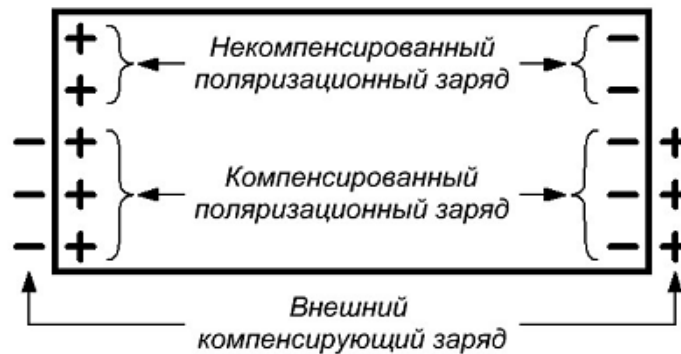
Рисунок 1.2 – Пироэлектрический кристалл в вакууме после изменения температуры [43]
