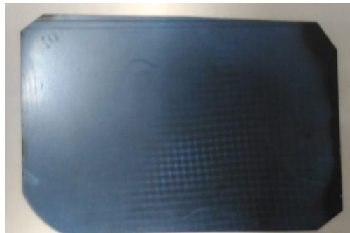
Рисунок 5.7 – Рентгеновское изображение сетки 12 (толщина 0,3 мм, размер ячейки 1x1 мм), полученное с использованием \text{LiNbO}_3:\text{Cu} при семи циклах нагрев-охлаждение
